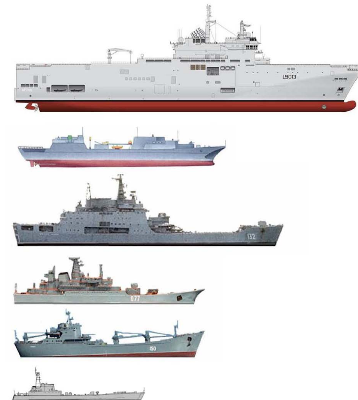
Figur A.1 Figuren viser, i samme målestokk, de viktigste av Russlands nåværende, tidligere og fremtidige amfibiske fartøyer, (ovenfra:) Mistral-klassen, Ivan Gren-klassen, Ivan Rogov-klassen, Roputsja-klassen, Alligator-klassen og Polnotsjnyj-klassen (Kilde: Patrick Thomas Baker, op. cit., s. 38).
