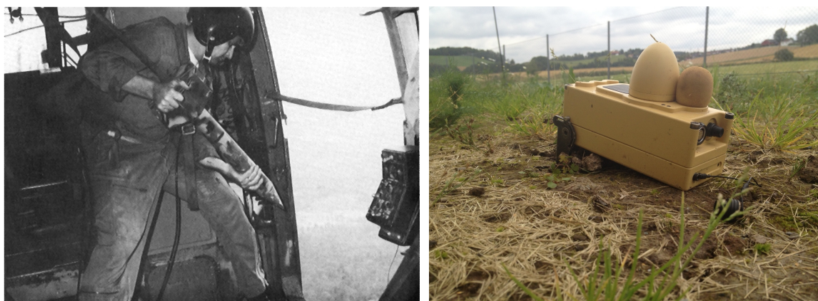
(a) Trådløs sensor (ADSID) droppet fra fly over Laos i 1967 (b) Seismisk trådløs marksensor i 2013
