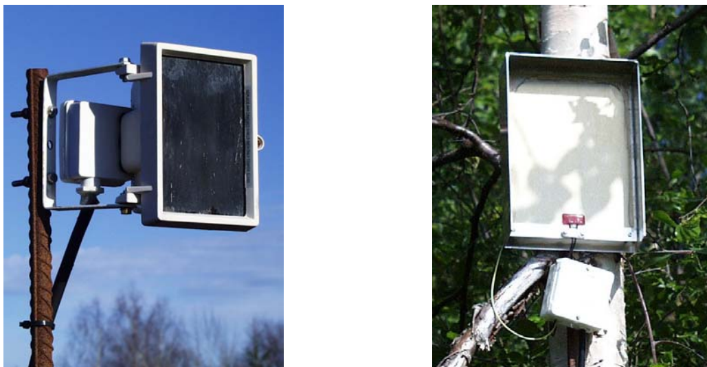
Figur 4.3 IR-markører, til venstre den som ble benyttet på Rygge (Halogenlampe hvor glasset var byttet ut med svartmalt aluminium), og til høyre varmemfolie som ble brukt på Bardufoss
