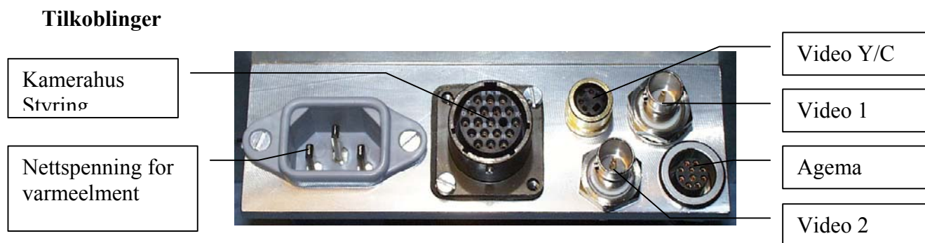
Figur 5.10 Kontakter for tilkobling av værhus, plassert under værhuset
