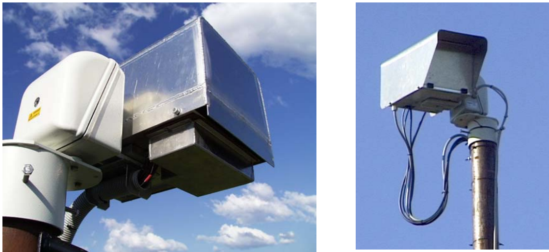
Figur 3.5 Værhus og pan/tilthode, bakfra (til venstre) og forfra (til høyre)
