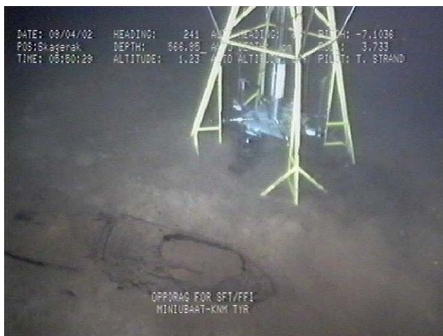
Figur 3.2 Sedimentprøver samles inn like ved en gjennomrustet flybombe ved siden av et vrakene undersøkt i 2002. Sennepsgass ble indentifisert i en av disse sedimentprøvene (Foto hentet fra: Tørnes m.fl. 2006).
