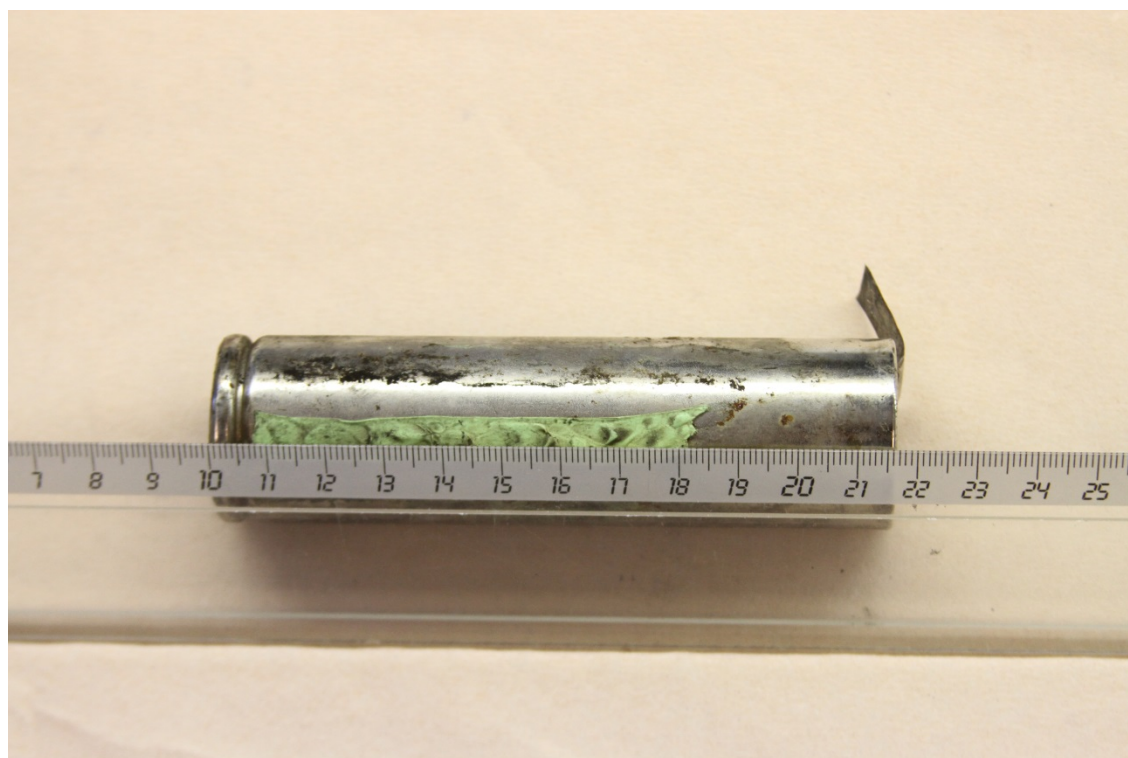
Figur 4.4 Celle nr. 8. Denne cellen blåste ut av batteriet og ble funnet i garasjeporten. Kannen er tom og lokket mangler. Bemerk at denne har lite rust, noe som sannsynliggjør at batteriet ikke har vært utsatt for en vannlekkasje.
