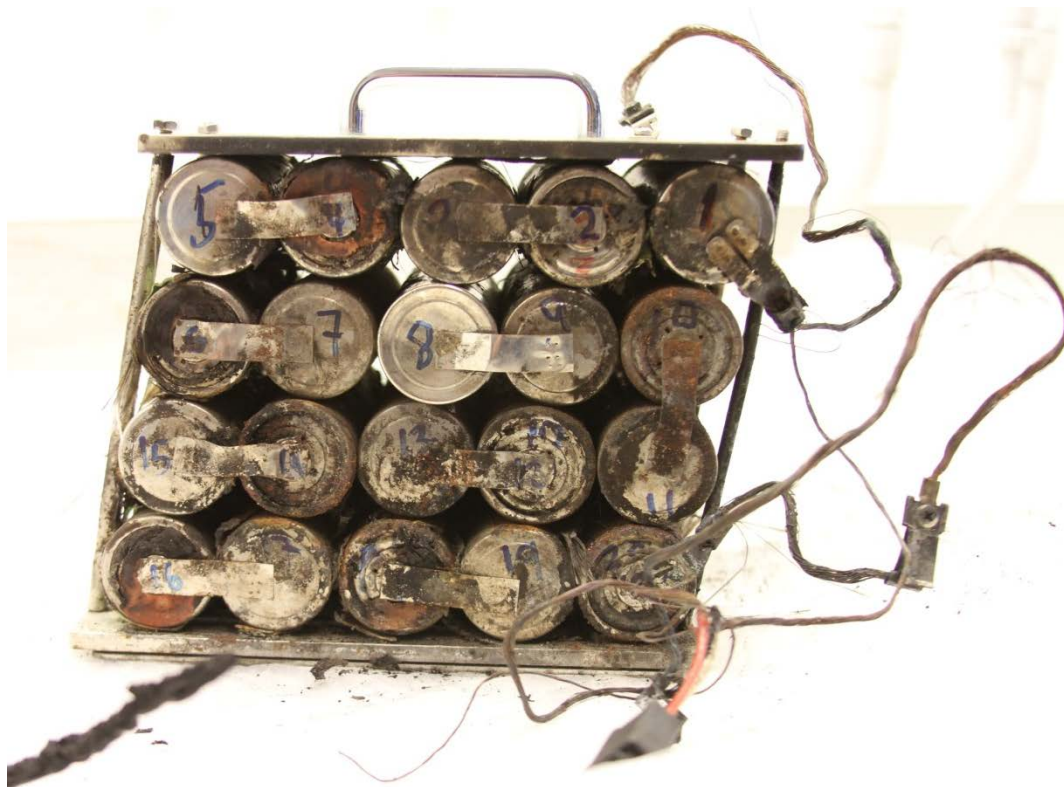
Figur 4.3 Cellene er nummerert fra 1 ved batteriets negative pol til 20 ved batteriets positive pol
