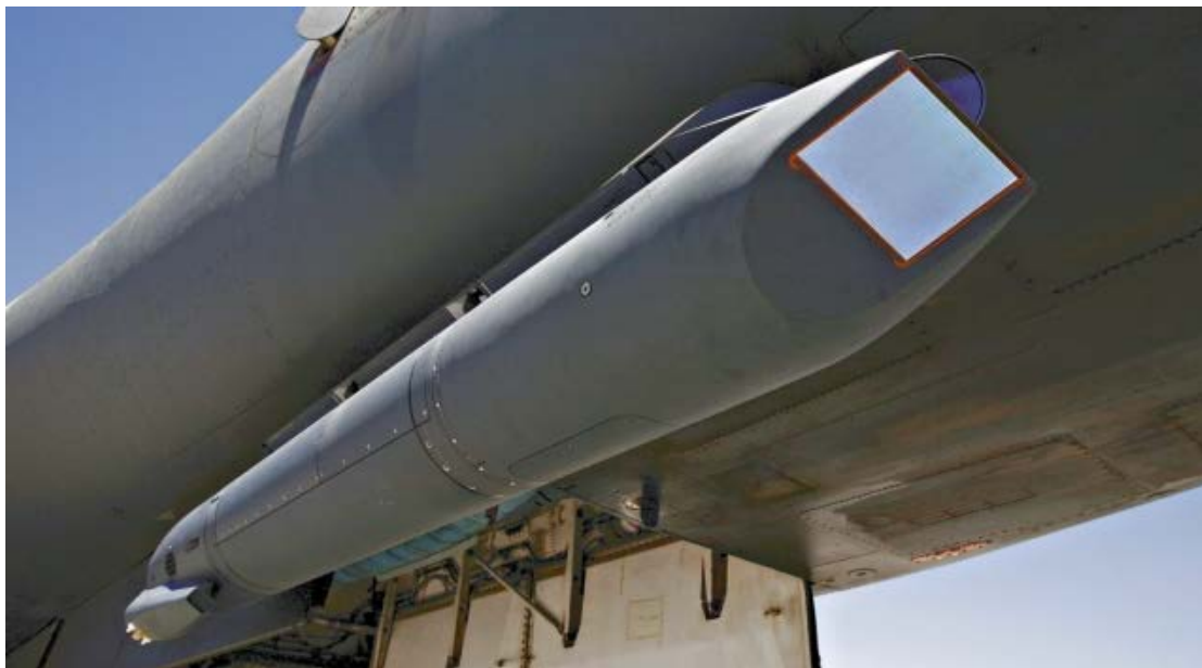
Figur 4.2 Sniper Advanced Targeting Pod (ATP), amerikanskprodusert målsøker, fotografert på et amerikansk B-1B Lancer strategisk bombefly i 2008. 188
