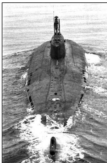
Figur 4.12 Ubåt av Oscar II-klassen sett bakfra. Ubåten er svært bred, og det skyldes i første rekke de 24 kryssermissilene som ligger i tolv utskytningsrør på hver side av tårnet. Lukene kan skimtes på bildet. Det er seks luker på hver side, og hver luke dekker to utskytningsrør. (Fra Wikimedia Commons, offentlig eiendom.)
