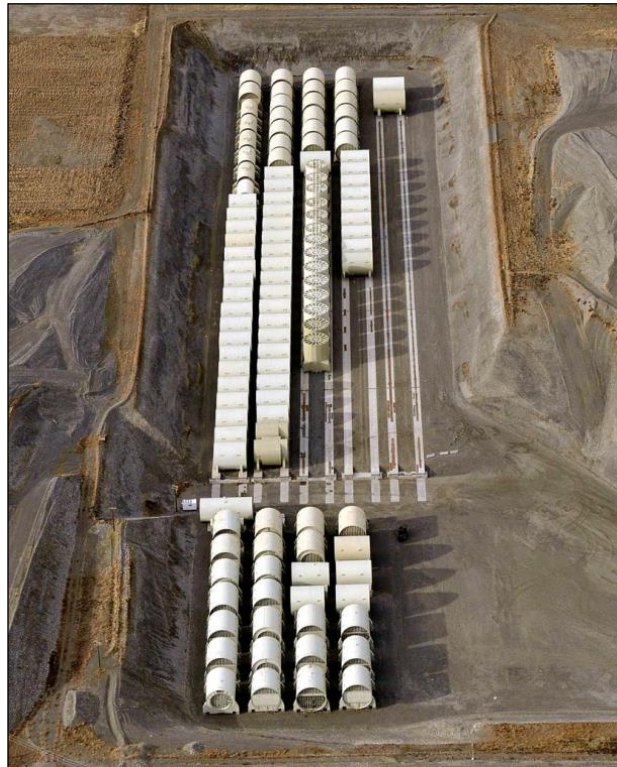
Figur 3.1 “Trench 94” på Hanford Site i delstaten Washington. Her samles alle reaktorseksjoner fra USAs atomubåter etter at ubåtene er tatt ut av tjeneste og hogd opp. Reaktorseksjonene er lagret åpent på denne måten for at andre stater skal kunne følge opphoggingsprosessen ved hjelp av satellittovervåking. Bildet skal være tatt i 2012 og viser 119 reaktorseksjoner. (Foto fra U.S. Navy via Wikimedia Commons, offentlig eiendom.)
