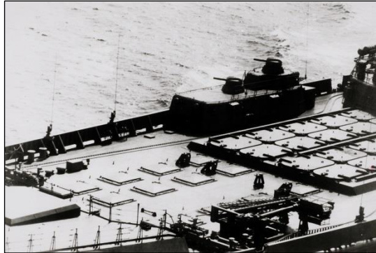
Figur 4.16 Dette bildet er tatt av U.S. Navy i 1985 og viser fordekket på daværende Frunze (senere omdøpt til Admiral Lazarev og tatt ut av tjeneste i 1998). Til høyre sees toppen på 20 utskytningsrør for missiler av typen SS-N-19 Shipwreck , og til venstre sees toppen på tolv utskytningsrør som hver kan skyte ut åtte missiler av typen SA-N-6 Grumble . På dagens skip av Kirov-klassen er SA-N-6 erstattet av SA-N-20 Gargoyle . (Fra Wikimedia Commons, offentlig eiendom.)
