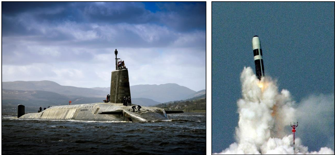
Figur 4.22 Bildet til venstre viser den strategiske ubåten HMS Vigilant (S 30) på vei tilbake til basen i Skottland i april 2014. Til høyre er et Trident II D5-missil nettopp avfyrt fra HMS Vanguard (S 28) vest i Atlanterhavet i 2005. Missilet skytes ut fra ubåten og når overflaten ved hjelp av trykkluft. Derfra overtar rakettmotorene. (Begge bildene er fra www.defenceimagery.mod.uk under Open Government Licence, offentlig eiendom.)
