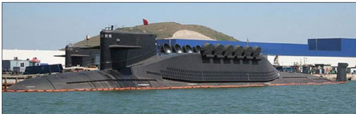
Figur 4.28 En ubåt av Jin-klassen med lukene til de tolv missilrørene åpne. Bildet skal være tatt i 2010 eller tidligere. (Fra Wikimedia Commons, offentlig eiendom.)
