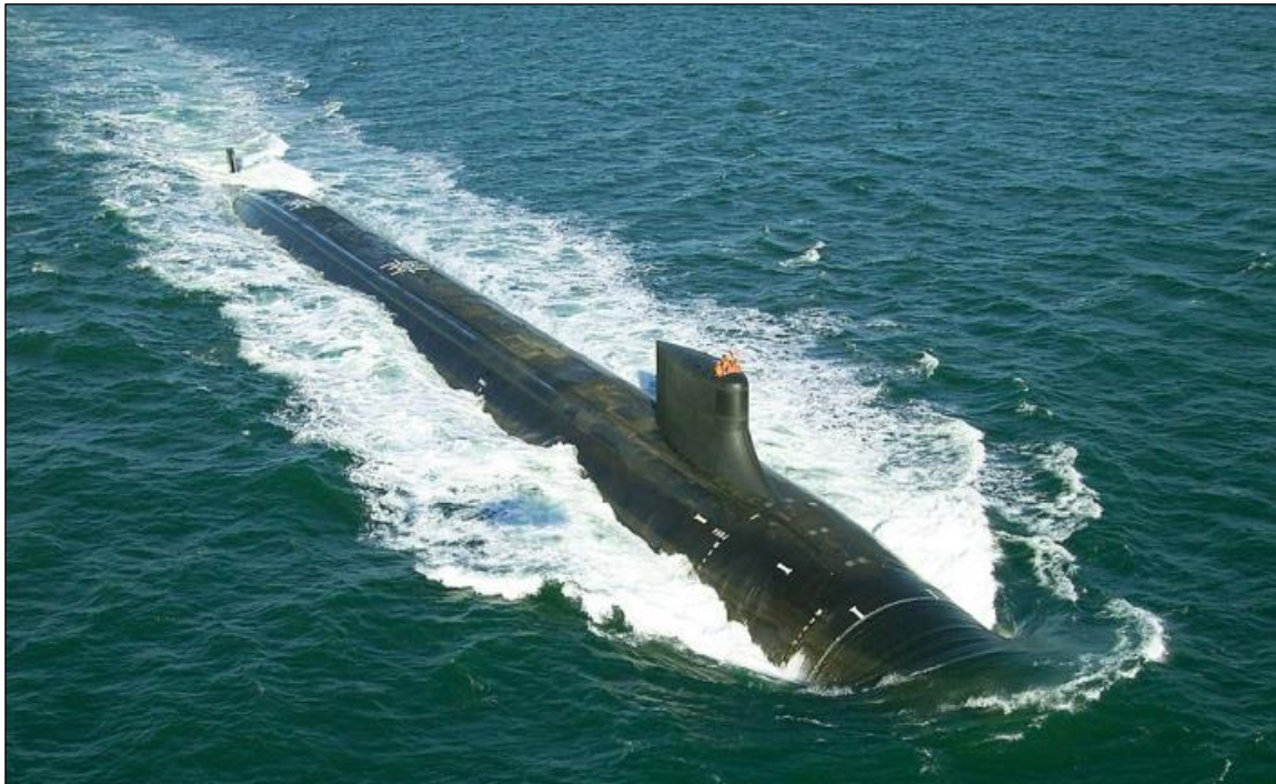
Figur 4.5 USS Jimmy Carter (SSN 23). Bildet viser ubåten under utprøving før den ble satt i tjeneste i 2005. Denne ubåten er 30 m lengre enn de to andre ubåtene i Seawolf-klassen. (Foto hentet fra www.navy.mil , offentlig eiendom.)
