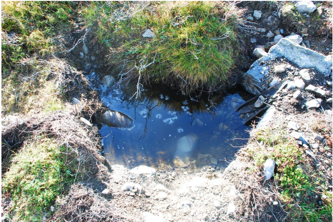
Figur C.5 Krater K6 prøve tatt første gang i 2010. Krateret er fylt med vann og har store fragmenter fra demolering av 155 mm granater.
