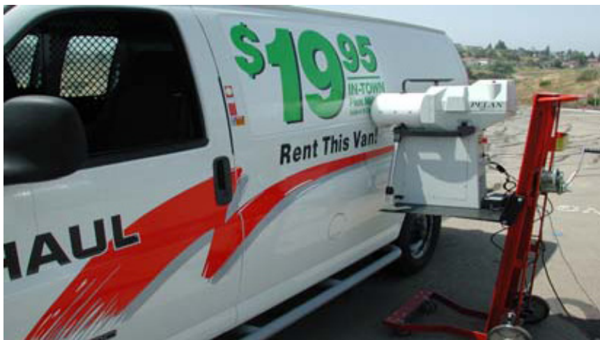
Figur 2.8 PELAN benyttet til undersøkelse av innholdet i en varebil. (Foto: SAIC).
