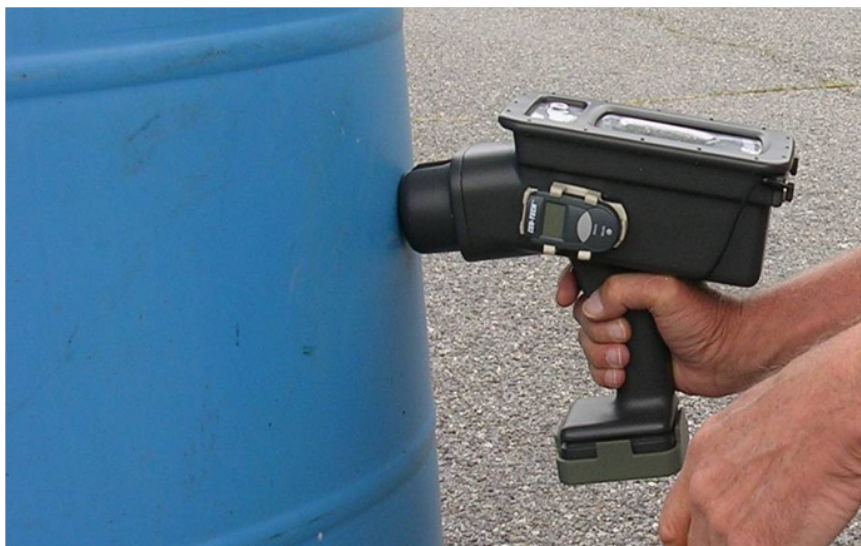
Figur 2.9 PASS brukt til inspeksjon av en tønne. (Foto: Spearhead Innovations).
