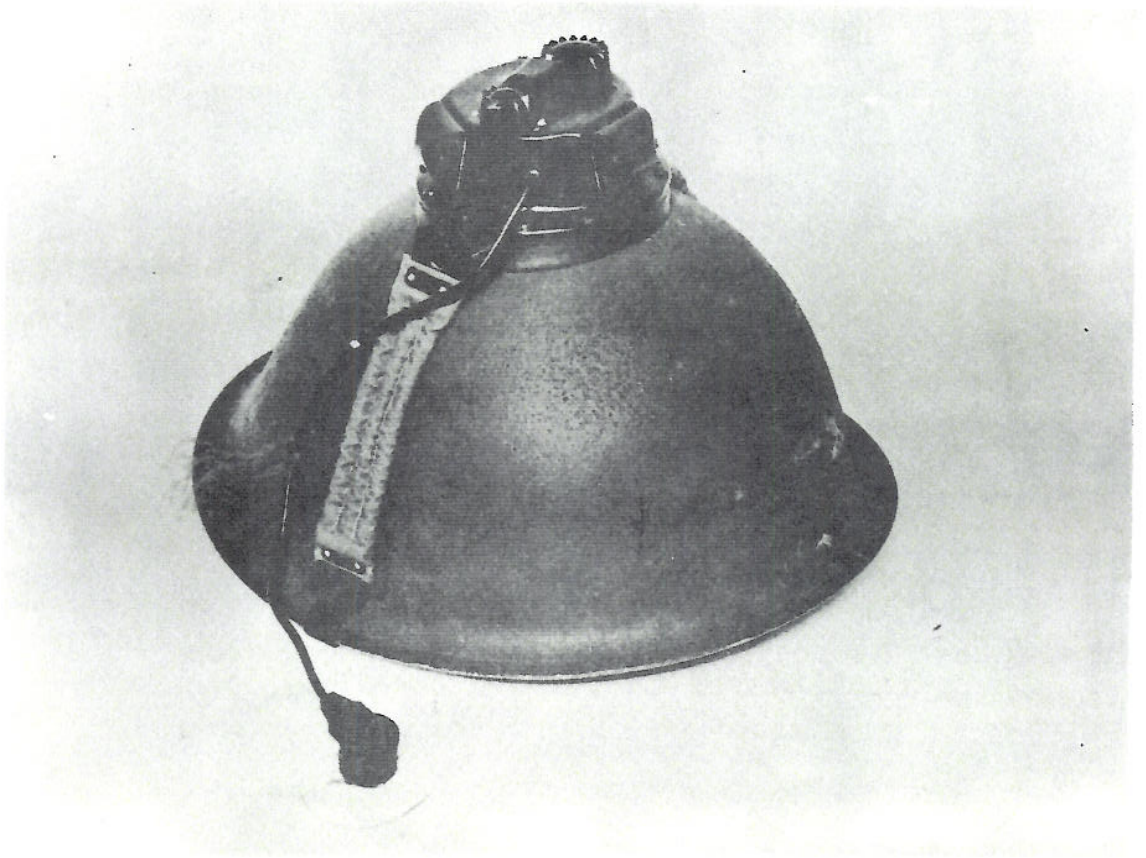
Figur 3.12 Akustisk IR-varsler monteret på hjelm (ENGLAND)
