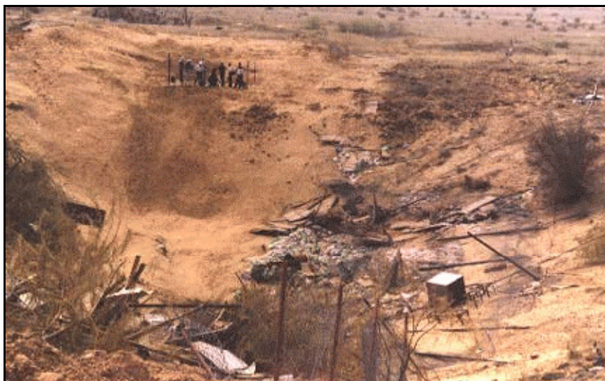
Figur 2.1 "Krater" etter fusjonsladningen Shakti-2 ved Pokhran prøvesprengningsområde. Ladningen ble detonert langt under bakken, men har ført til en sammensynkning over eksplosjonsstedet. Dette er vanlig ved underjordiske eksplosjoner. Fotografiet er utgitt av den indiske regjeringen og tatt fra (7).
