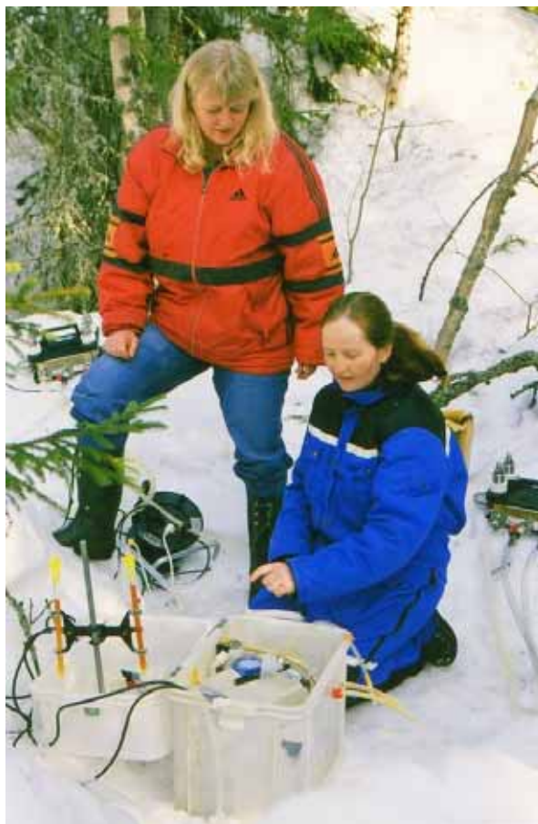
Figur 2.7 Steinsjøen 26. mars 2003. In situ størrelse og ladnings fraksjonering.
