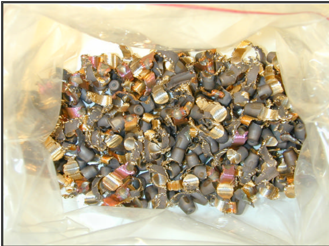
Figur 3.3 Rester av freste prosjektiler.
