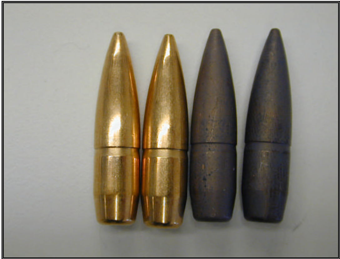
Figur 3.1 Prosjektiler før (t.v) og etter (t.h) anløping av den herdede stålkjernen. Det ble dannet et grå/brunt oksidbelegg på overflaten av prosjektilene
