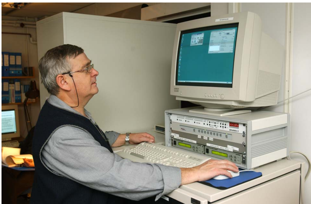
Figur 11-6 Kommunikasjonsenhetene i laboratoriet. HF-modemene og satelittkommunikasjons simulatoren kan sees i kabinettet under terminalen.
