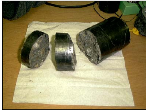
Figur 4.3: Betongprøver før og etter testing. Den svarte overflaten er molybdenfett som har fått en grafittlignende struktur under testen.
