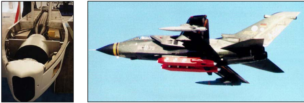
Figur 8.1: Tysk Tornado jagerbomber som bærer to KEPD 350 "TAURUS" missiler. Venstre bilde viser missilets tandem-konstruksjon, med hulladning og hovedpenetrator (Janes Air Launched Weapons version 42)
