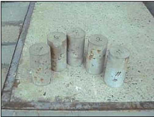
Figur 4.3: Betongprøver før og etter testing. Den svarte overflaten er molybdenfett som har fått en grafittlignende struktur under testen.
