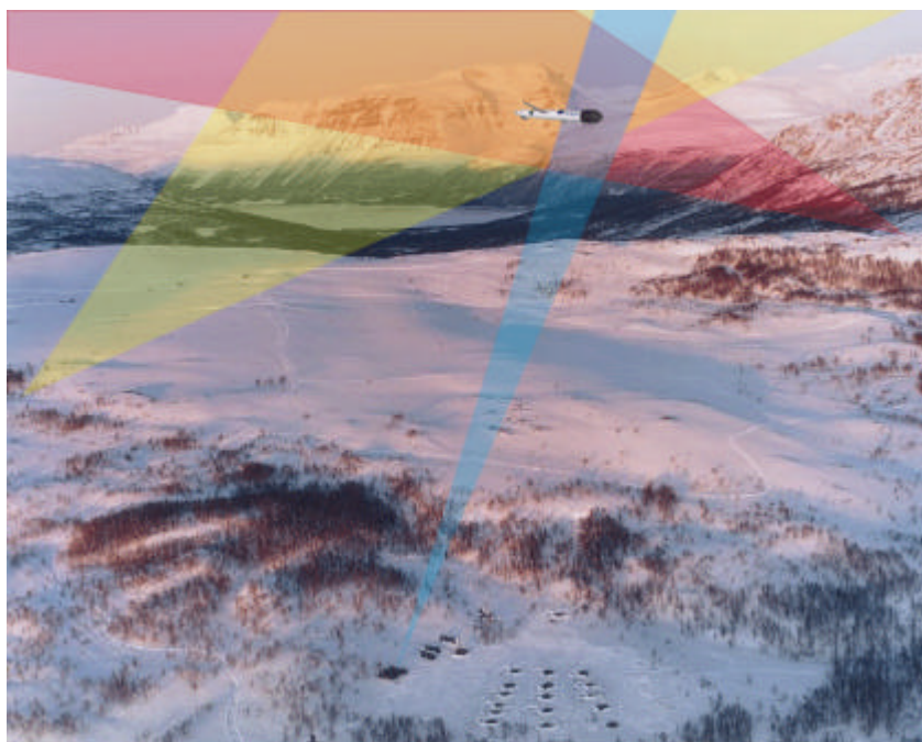
Figur 1.1 Illustrasjonen viser en multistatisk radar hvor to senderenheter med brede lober belyser et passerende missil, mens den passive mottagerens smale lobe fanger opp spredt energi fra det belyste volumet.
