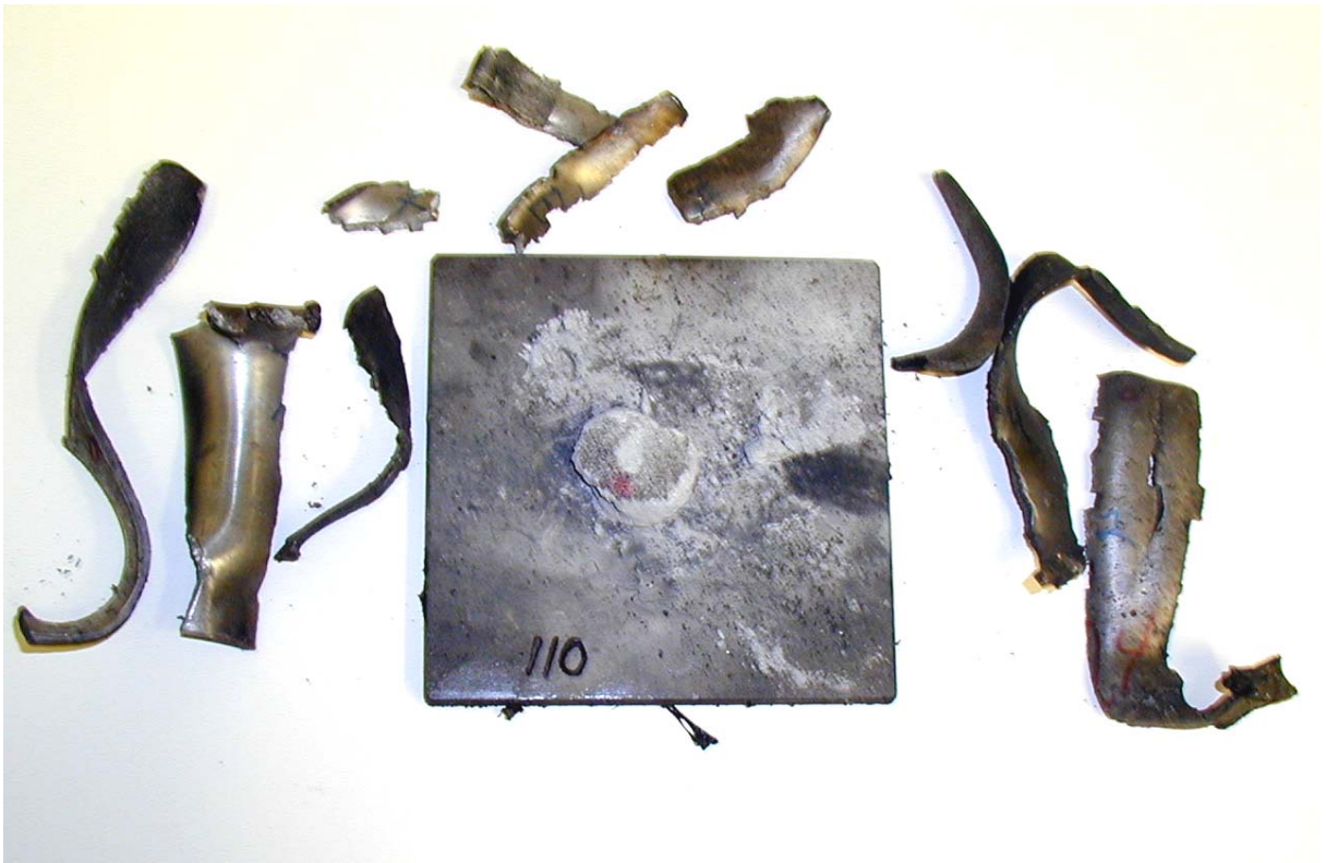
Figur 3.25 Rester fra skudd 9, rør 24, 110 kort, ikke omsetning.
