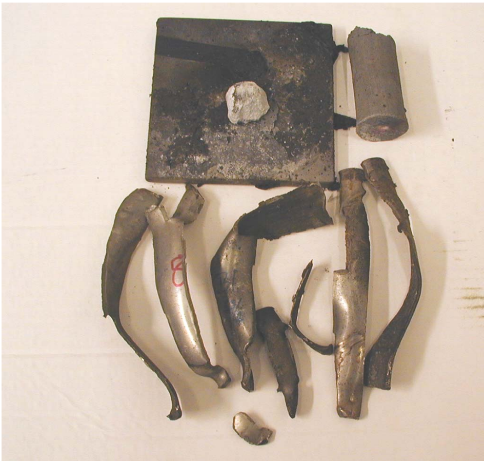
Figur 3.18 Skudd 2 for serie B, rør 8, 110 kort, ikke omsetning
