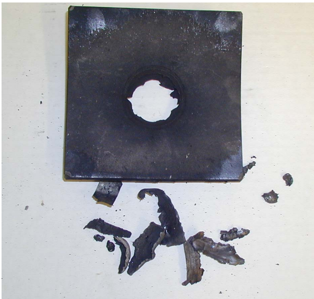
Figur 3.7 Skudd 4 rør 4 160 kort (421 mm), full omsetning.
