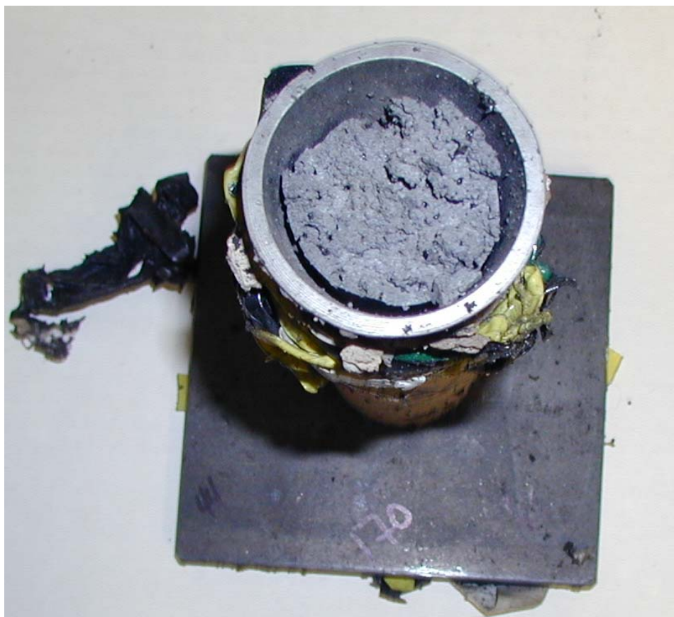
Figur 3.9 Skudd 6 rør 6, 170 kort, ikke omsetning.
