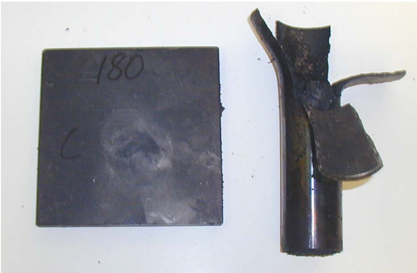
Figur 3.36 Skudd 9 med 180 kort, rør 31, ikke omsatt.
