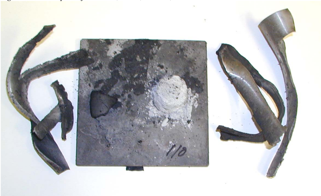
Figur 3.22 Rester fra skudd 6, rør 12, 110 kort ikke omsetning.
