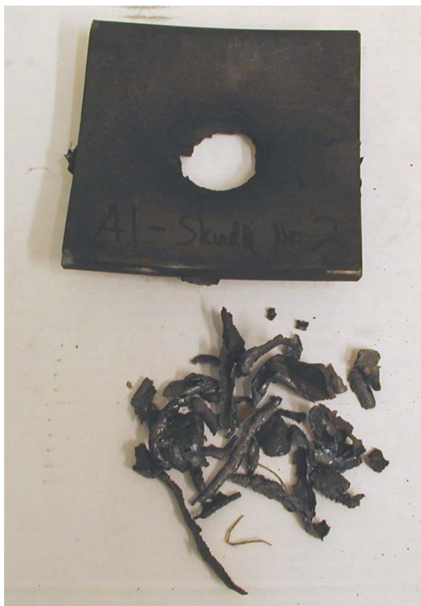
Figur 3.5 Skudd 2 rør 2 med 150 kort, full omsetning.
