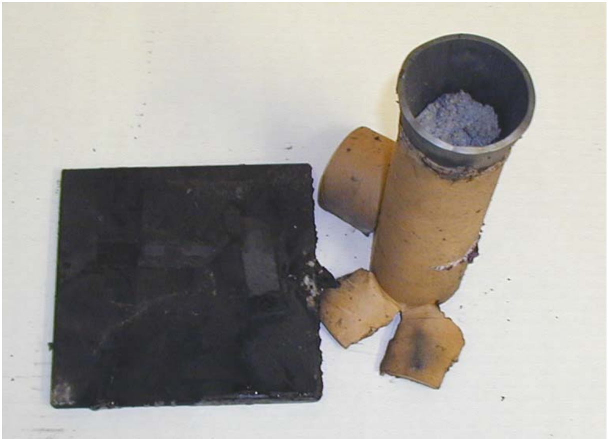
Figur 3.11 Skudd 8, rør 20, 160 kort, ikke omsetning.
