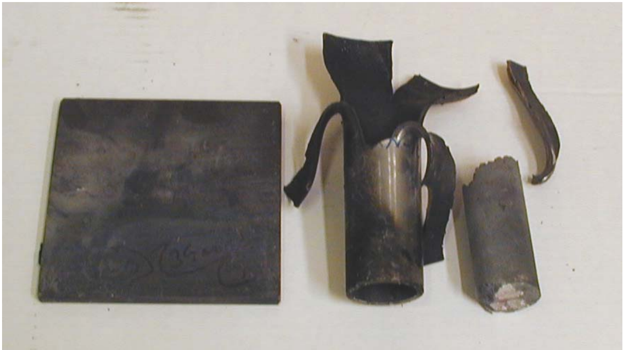
Figur 3.12 Skudd 9, rør 21, 150 kort, ikke omsetning.
