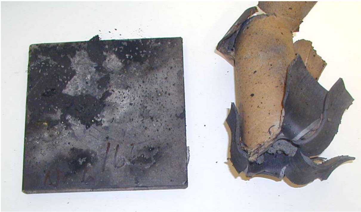
Figur 3.33 Skudd 6 med 165 kort, rør 17, ikke omsetning.
