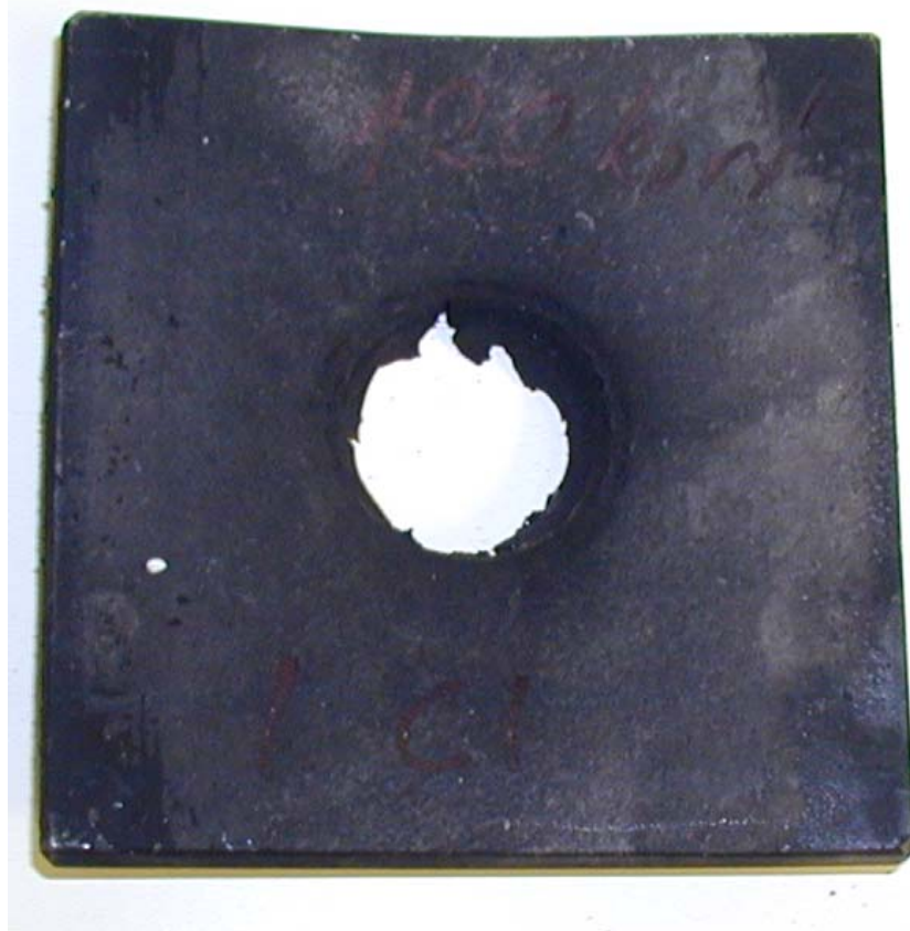
Figur 3.28 Skudd 1 med 120 kort, rør13, omsatt.
