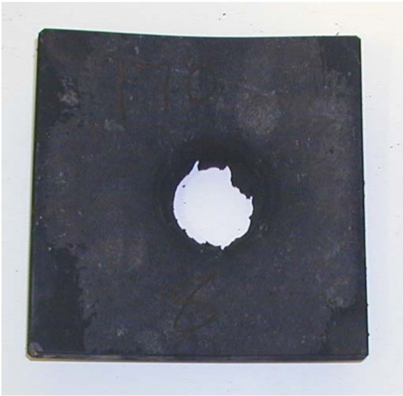
Figur 3.35 Skudd 8 med 170 kort, rør 30, omsatt.
