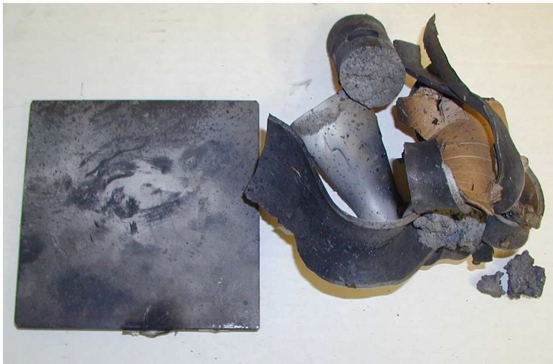
Figur 3.6 Skudd 3 rør 3, 170 kort, ikke omsetning.
