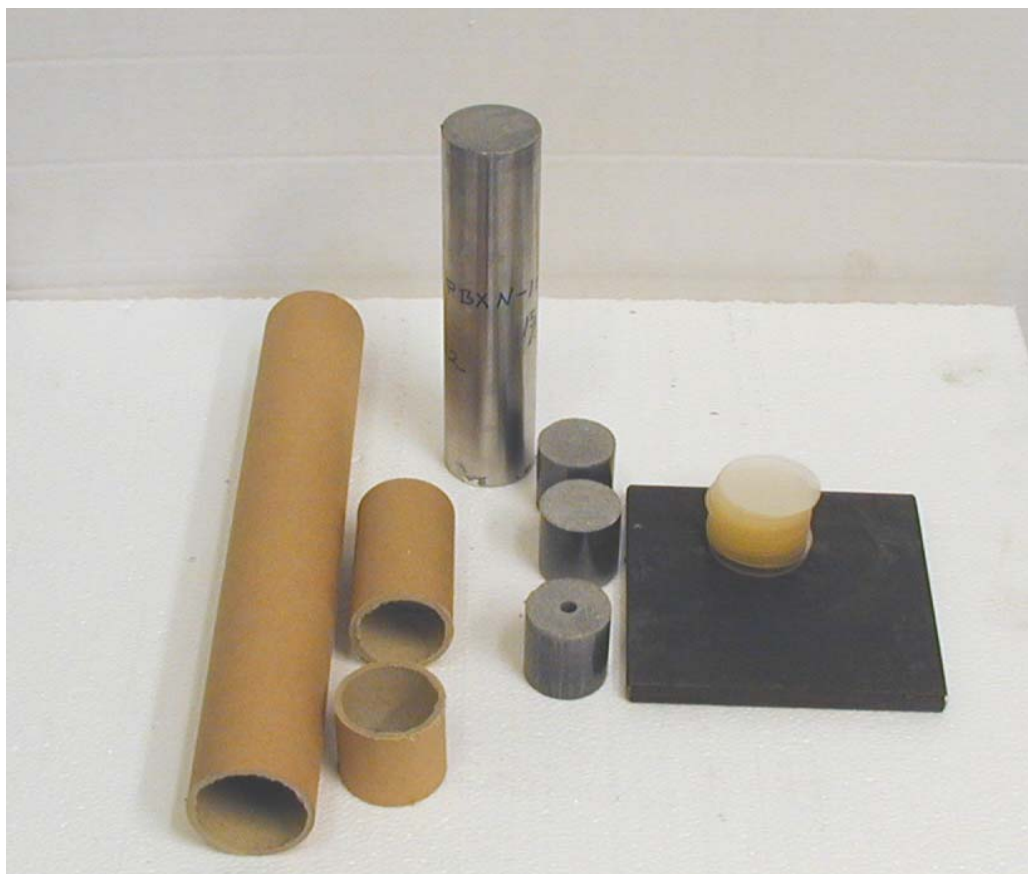
Figur 2.2 Delene som benyttes for sammenstilling av et skudd i GAP-test.
