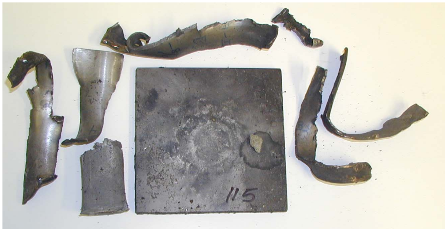
Figur 3.24 Rester fra skudd 8, rør27, 115 kort, ikke omsetning.
