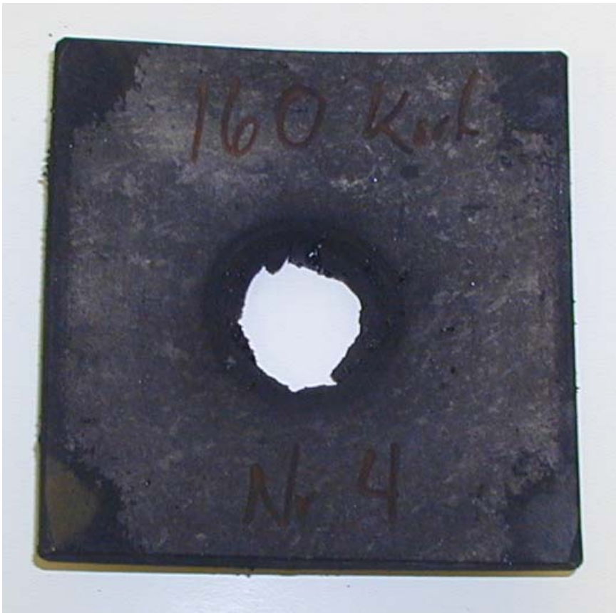
Figur 3.31 Skudd 4 med 160 kort, rør16, omsatt.
