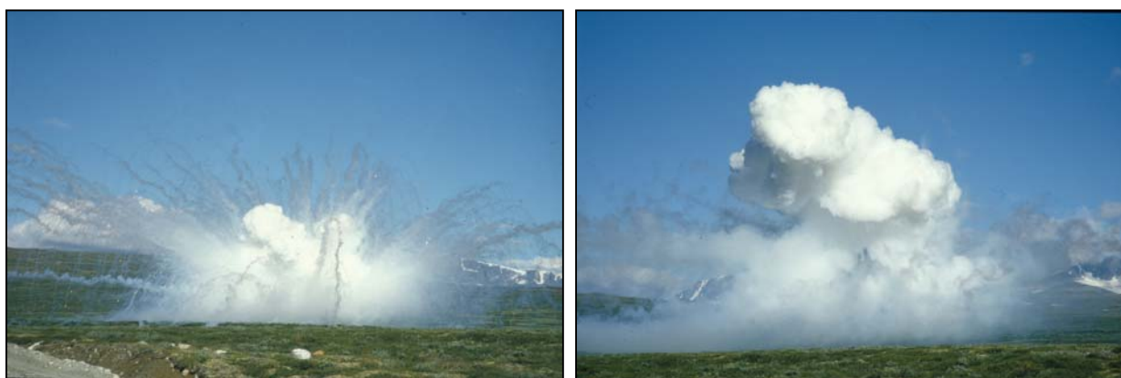
Figur 2.1 Sprengning av en 107 mm WP-granat med 3,4 kg hvitt fosfor. En hvit sky av fosforsyre stiger til værs (Foto: John Tørnes, FFI)
