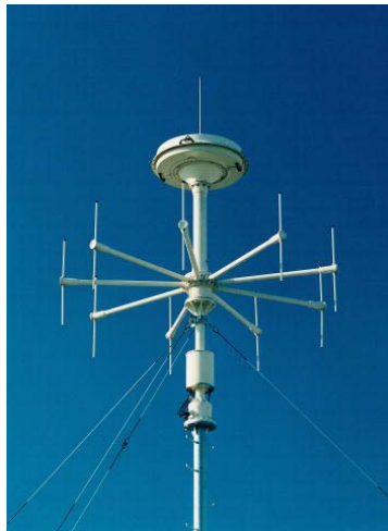
Figur 4-2 Eksempel på antennearray med 9 elementer (20MHz - 3GHz Rohde & Schwarz)
