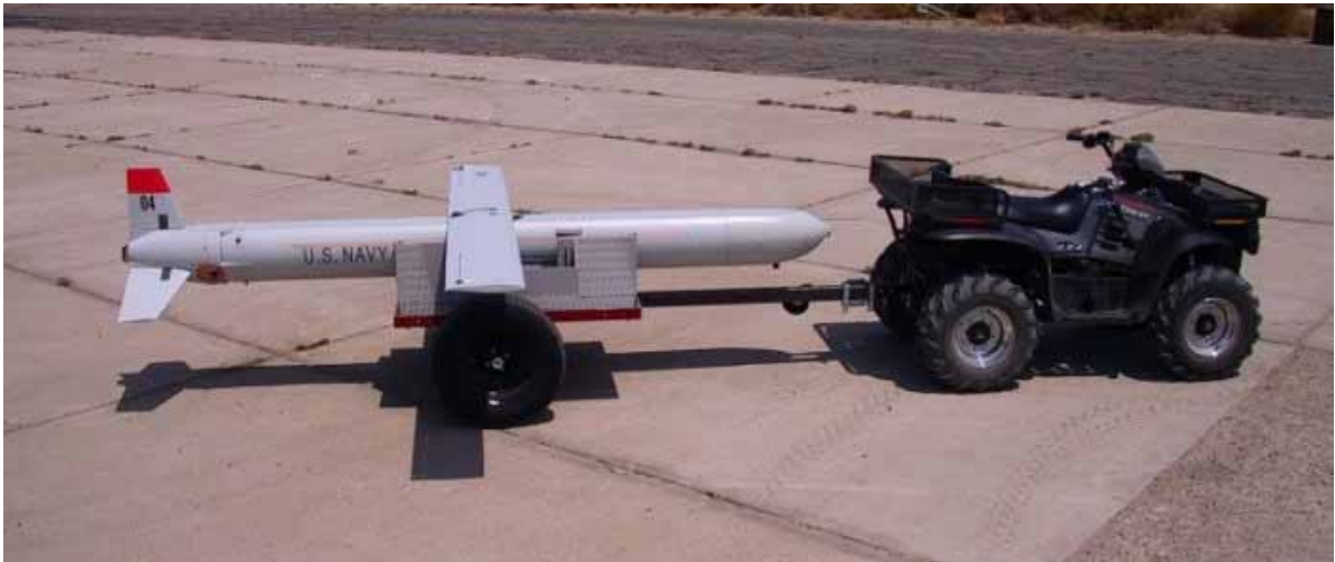
Figur 6.4 Affordable weapon er et eksempel på at det kan lages billige kryssermissiler av kommersielle hyllevarer komponenter. Affordable Weapon skal kun koste 40000 US$ per missil.
