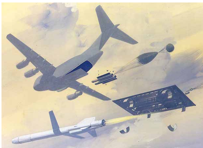
Figur 4.3 FOAS (Future Offensive Air Systems) demonstrerer hvordan lasteflyet kan brukes som plattform for levering av langtrekkende ild uten modifikasjoner av lasteflyet. Bildet er tatt fra FOAS' nettsider.
