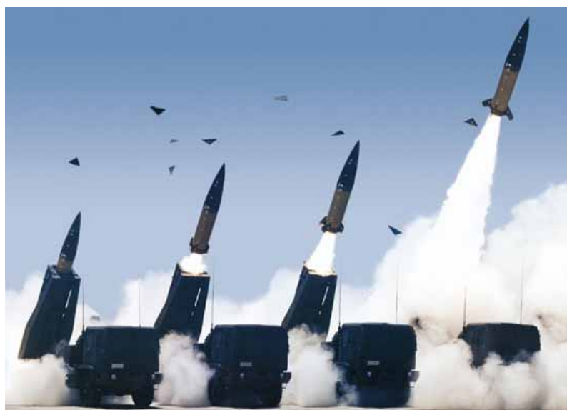
Figur 4.9 Utskytning av ATACMS fra lette mobile HIMARS launchere demonstreres. Det er produsert flere varianter av ATACMS (inkludert en med unitært stridshode).
