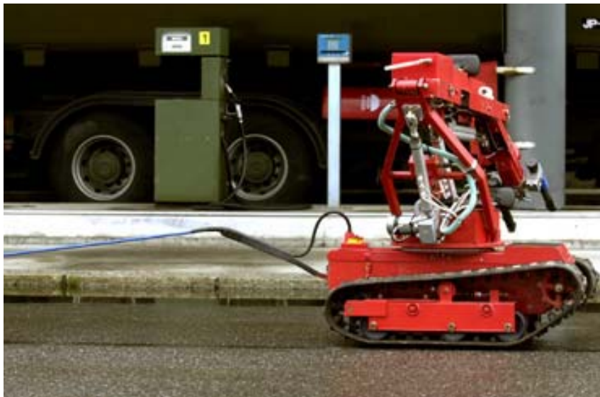
Figur 2.8 Ubemannete kjøretøyer brukes allerede i dag av Forsvaret ifm. eksplosivrydding. Slike hjelpemidler kan forventes å få stadig større nytte ifm. antiterror- og stabiliseringsoperasjoner
