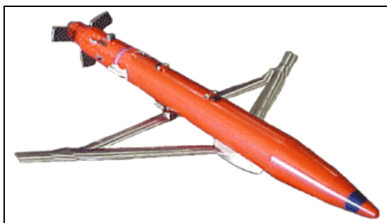
Figur 4.9 Slank, men kraftig: Small Diameter Bomb er 190 cm lang og bare 19 cm bred. Bomben bærer 20 kg sprengstoff og skal tilpasses de fleste amerikanske bombe- og kampfly
