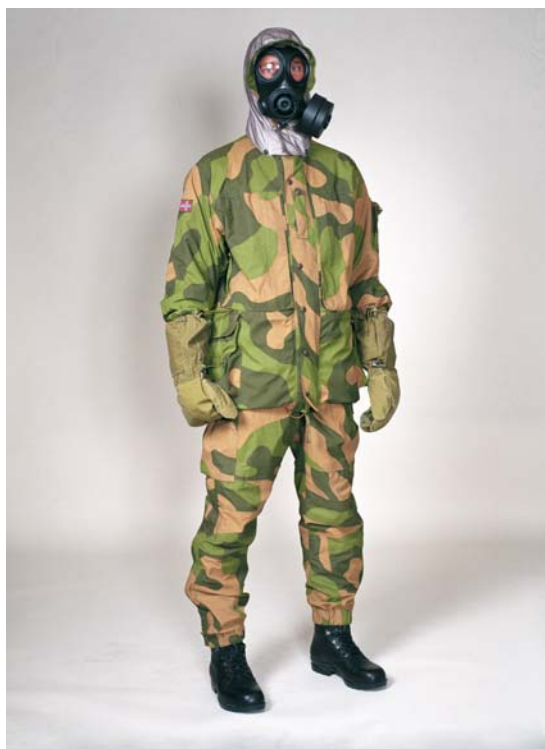
Figur 7.5 NORMANS' integrerte beskyttelse i to lag. Vanlig ytterbekledning med membrantekstil og et fôr med adsorberende aktivt kull
