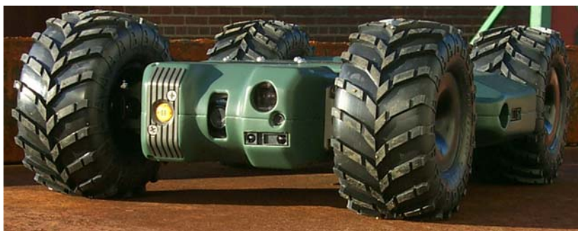
Figur 2.9 Dragon Runner er et lett bærbart kjøretøy (ca. 4,5 kg) som er blitt benyttet i Irak og Afghanistan. Her kan benyttes ulike typer sensorer, f.eks. for visuell inspeksjon eller sniffing etter eksplosiver
