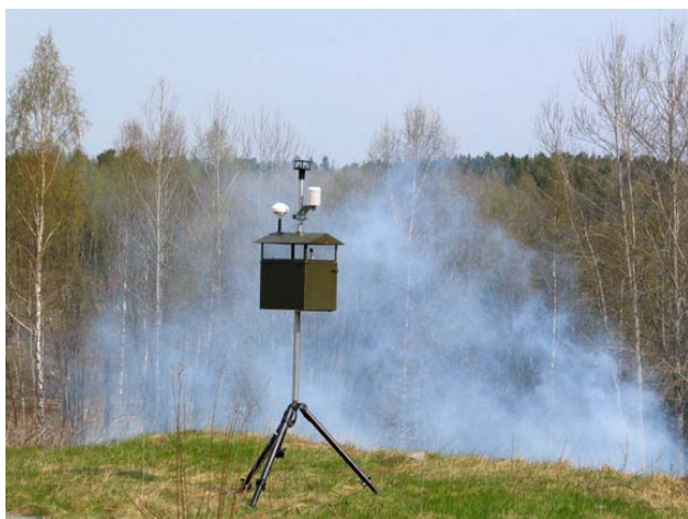
Figur 7.2 CATSS (Chemical, Atomic and Toxic compounds Surveillance System) er et nyutviklet automatisk, nettverksbasert overvåkningssystem for radioaktiv stråling, kjemiske stridsmidler og giftige industrikjemikalier
