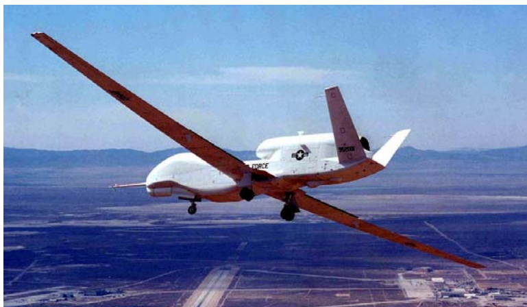
Figur 10.6 I tillegg til overvåkning vil den store UAVen Global Hawk i fremtiden trolig også få viktige roller som sambandsrele og GPS-pseudolitt over områder hvor amerikanske tropper er på oppdrag
