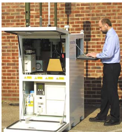
Figur 7.6 Smiths Detection, UK, har utviklet punktdetektoren NB Cerberus for deteksjon av kjemiske og biologiske stridsmidler. Den inneholder instrumenter for måling av partikkelstørrelse og -form, samt en biodetektor
