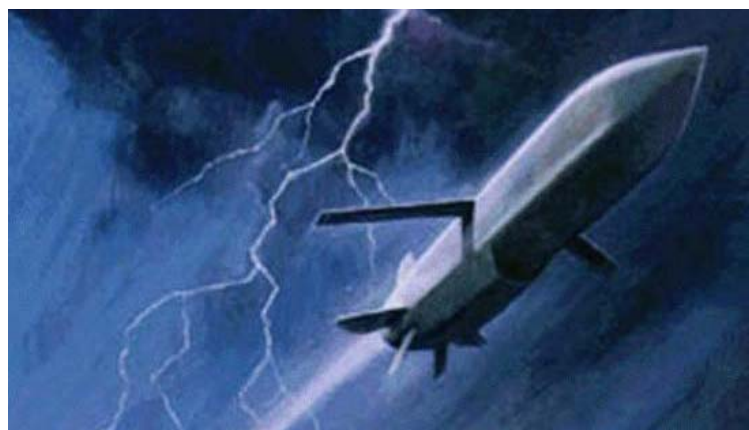
Figur 5.1 Britisk/franske Storm Shadow ble for første gang brukt (fra fly) under Irak-krigen våren 2003. Dette kryssermissilet har lav radarsignatur og et meget avansert stridshode. Rekkevidde for første versjon er ca. 350 km. Det vil også komme en maritim versjon etter 2010 med lengre rekkevidde
