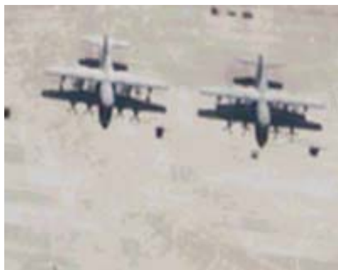
Figur 6.4 Quickbird er den eneste av dagens kommersielle overvåkningssatellitter som tilbyr bilder med oppløsning i underkant av 1 meter (reklamebilde fra DigitalGlobe Inc)
