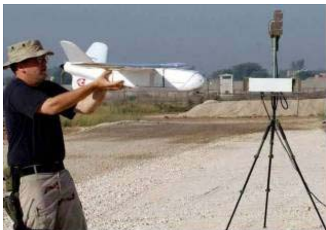
Figur 2.7 US Air Force har utviklet en UAV med betegnelsen Desert Hawk som først ble tatt i bruk under operasjon "Enduring Freedom" i Afghanistan. Denne kan benyttes til overvåkning og rekognosering i nærområdet, og har maksimal flytid på ca. en time. Desert Hawk kan bestykes med termisk eller dagslyskamera og overføre video i sann tid
