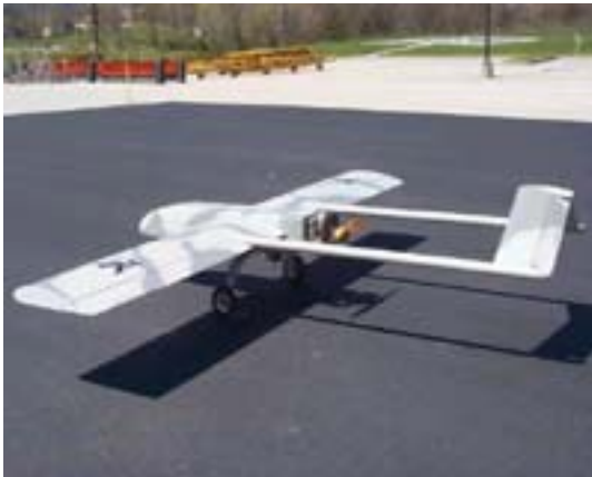
Figur 8.5 Det forventes at SAR vil bli tatt i bruk på stadig mindre UAVer i fremtiden. Her et bilde av US Armys Shadow UAV (vingespenn 3,7 m) som foreløpig bare benytter elektrooptiske sensorer
