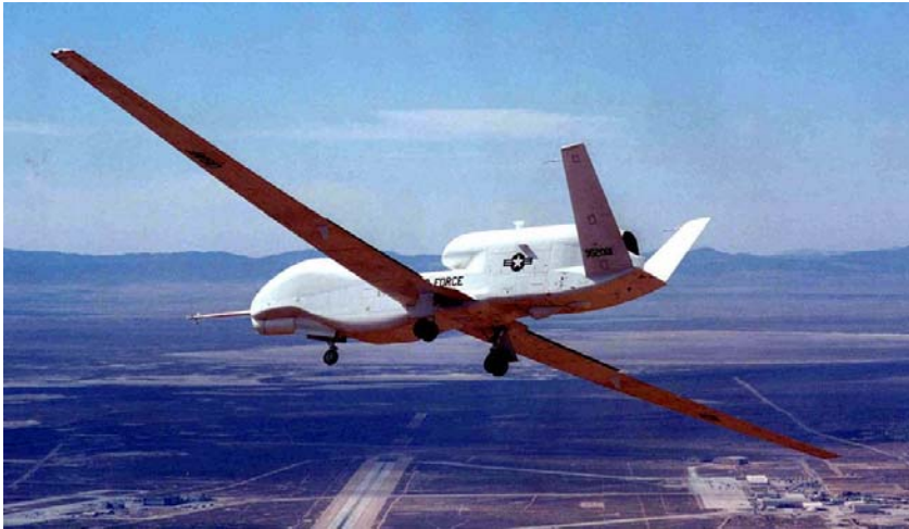
Figur 8.4 NATOs AGS-system vil bestå både av bemannede fly og Global Hawk UAV (bildet) med meget avansert SAR for detaljert avbildning og MTI. Det blir viktig for norske styrker å kunne utnytte både bilder og MTI-data fra AGS-systemet
