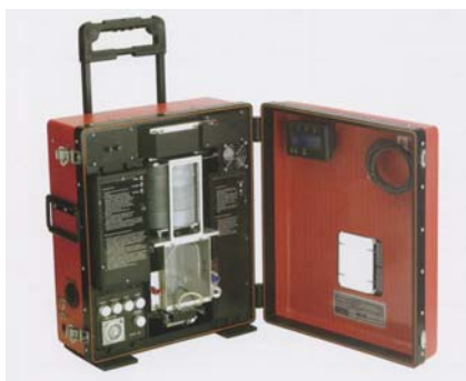
Figur 7.10 FFI benytter SpinCon lufthøster utviklet av Sceptor Industries, USA, til oppsamling av sopp, bakterier og virus i luft, for videre identifisering vha. mikrobiologiske og molekylærbiologiske teknikker
