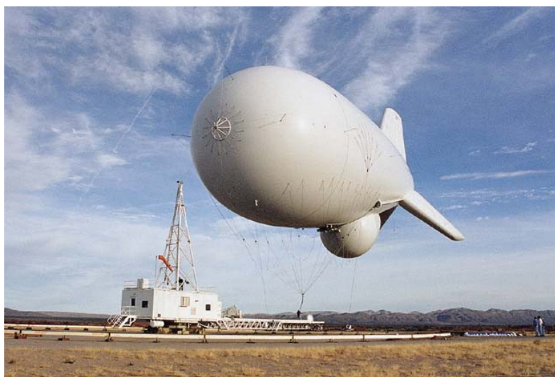
Figur 4.8 Et høytsvevende program: JLENS aerostat skal brukes til forsvar mot kryssermissiler ved baser utenlands
