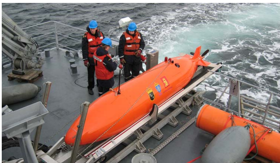
Figur 3.5 Norske HUGIN er en av de første autonome undervannsfarkostene som tas i bruk operativt (her på KNM Karmøy). Ubemannete undervanns- og overflatefarkoster vil i de neste par tiårene være en av de viktigste nye teknologielementene på sjøsiden. De vil imidlertid primært støtte de tradisjonelle fartøyene, ikke utkonkurrere dem
