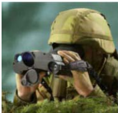
Figur 8.6 Moderne mållokaliseringsystemer (her: SIMRAD LP-1) gir øyeblikkelig målets koordinater, ved at instrumentet kombinerer GPS-mottaker, digitalt kompass, helningsmåler og laseravstandsmåler. Andre laserinstrumenter vil f.eks. kunne brukes til avlytting av samtaler inni bygninger
