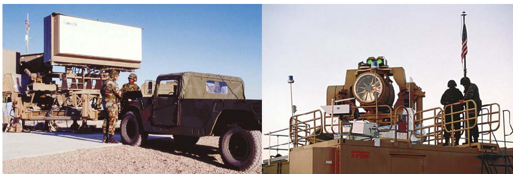
Figur 2.6 MTHEL er et laservåpen som skal bekjempe raketter og granater
