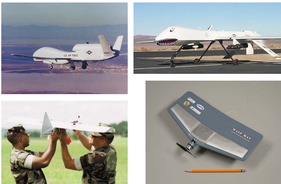
Figur 4.6 Dagens UAVer finnes i alle størrelser og fasonger. Øverst: Global Hawk og Predator er store og etter hvert velprøvde sensorplattformer; Predator leverer også våpen mot bakkemål. Nede venstre: 2 kg tunge Dragon Eye kan puttes i ryggsekken, og brukes til taktisk rekognosering for mindre forband. Nede høyre: DARPA utvikler flere mikro-UAVer; WASP MAV (Micro Air Vehicle) har utholdenhetsrekorden på nær 2 timer
