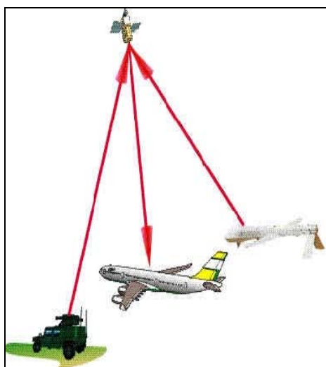
Figur 10.2 Laserstråler har større informasjonskapasitet enn radiobølger. I første omgang vil laserkommunikasjon bli tatt i bruk mellom amerikanske satellitter, men det er sannsynlig at vi også vil få se lasersamband mellom satellitter og store, høytflyvende UAVer eller overvåkningsfly innen 2020. Lasersamband til taktiske enheter på bakken er neppe aktuelt pga. problemer ved skydekke
