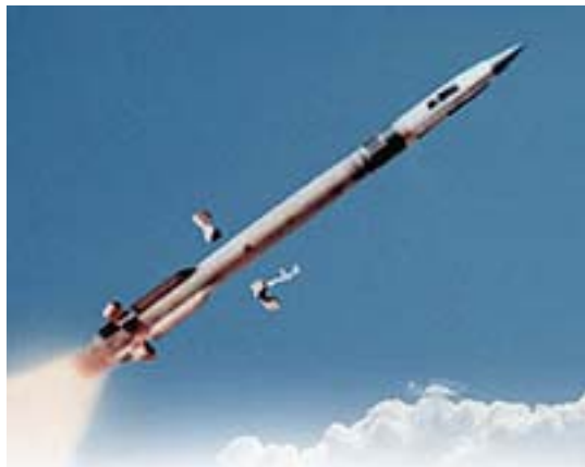
Figur 5.4 Patriot-3 missilet er primært basert på direkte treff, ikke nærhetsbrannrør. Missilet har en viktig rolle i terminalfasen i forsvaret mot ballistiske raketter. Det legges imidlertid inn mye innsats i USA for å utvikle systemer som kan stoppe ballistiske raketter allerede i oppskytningsfasen eller høyere opp enn Patriot-systemet
