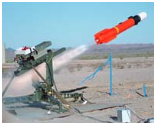
Figur 5.2 JCM (her under utprøving) skal erstatte Hellfire og Maverick på amerikanske fly og helikoptre fra ca. 2010. Piloten kan velge om missilet skal styres med laserpeking, eller om det skal bruke sin egen IR- eller radarsøker. Rekkevidden fra fly vil være ca. 28 km. Missilet vil være anvendbart mot stridskjøretøy, bygninger og mindre sjømål
