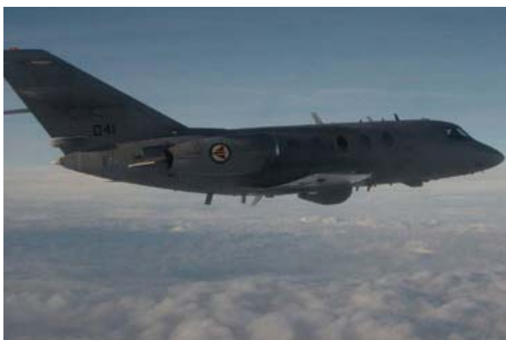
Figur 9.4 Norges lille park av Dassault DA-20 EK-fly forventes å nå slutten av sin operative levetid rundt 2015. Et sentralt spørsmål vil være hvordan luftbåren EK skal utøves etter 2015. Jamming kan f.eks. tenkes gjort fra en noe mindre UAV
