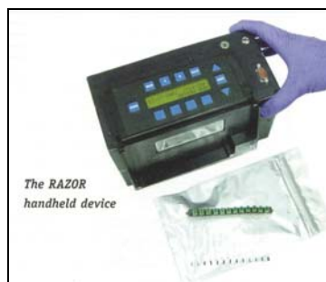
Figur 7.8 RAZOR er et håndholdt PCR instrument utviklet av Idaho Technologies
