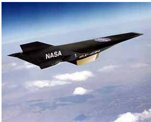
Figur 4.10 NASAs 3,7 m lange scramjet-demonstrator X-43A fløy i november 2004 i nær mach 10. Scramjet-motorer er spådd å kunne revolusjonere luftfart i fremtiden
