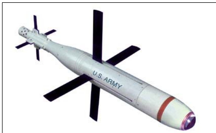
Figur 2.4 Flere produsenter tilbyr nå laserstyrt ammunisjon for 120 mm bombekaster
