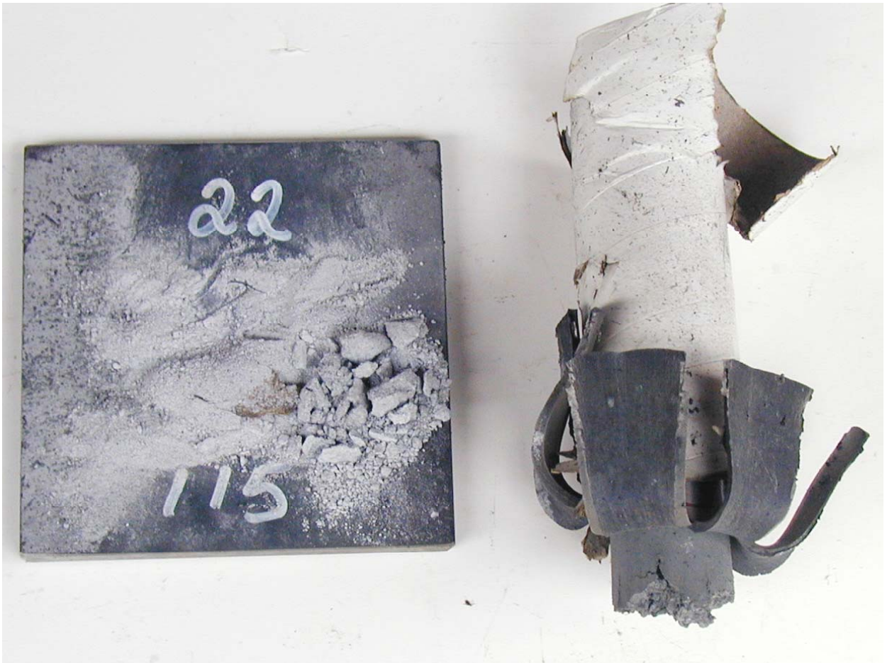
Figur 3.26 Skudd 19, rør 22 med PBXN-109 RS-RDX Ch. 719/03, 115 kort, ikke omsatt.
