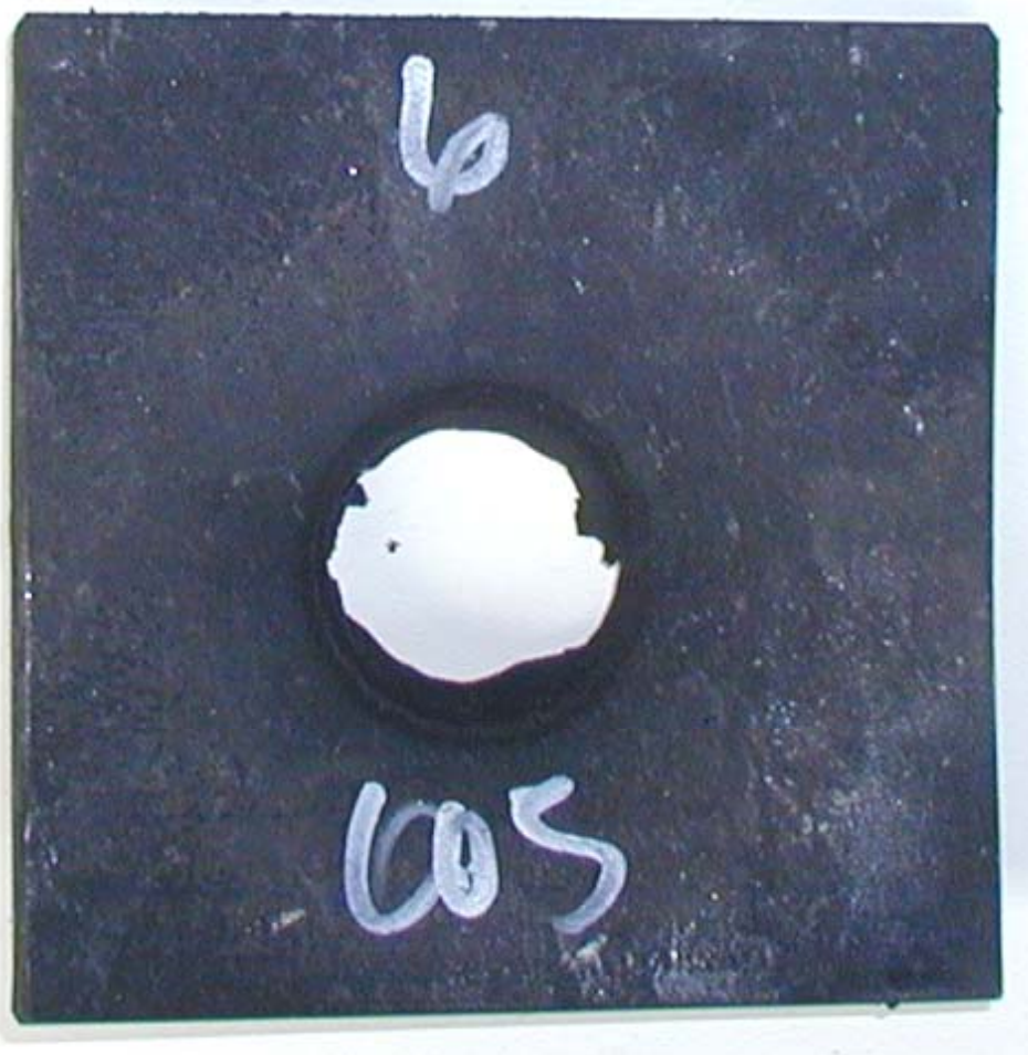
Figur 3.12 Skudd 6, rør 6 med PBXN-109 RS-RDX Ch.167/03, 105 kort, omsatt.
