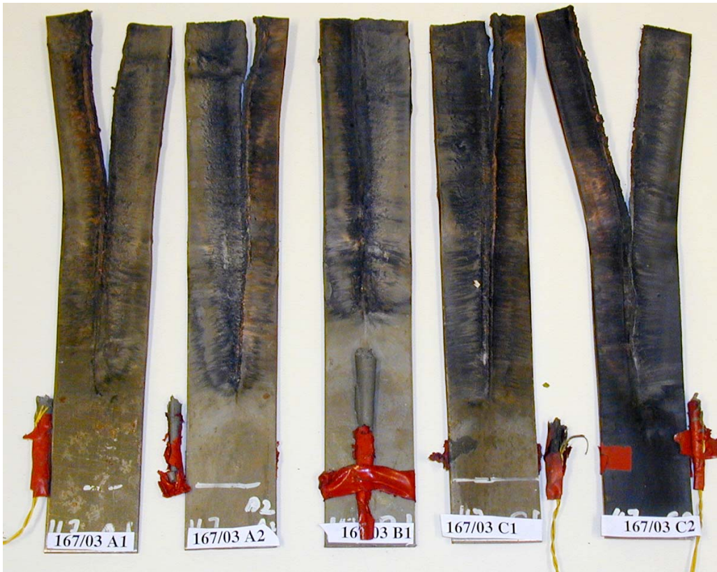
Figur 3.4 Vitneplatene og restene av eksplosivkonene for RS-RDX Ch. 167/03.
