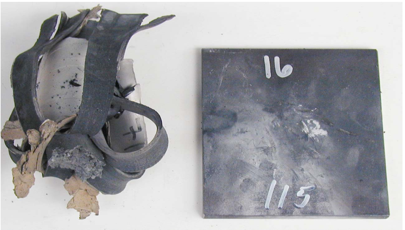
Figur 3.23 Skudd 16, rør 16 med PBXN-109 RS-RDX Ch. 719/03, 115 kort, ikke omsatt.
