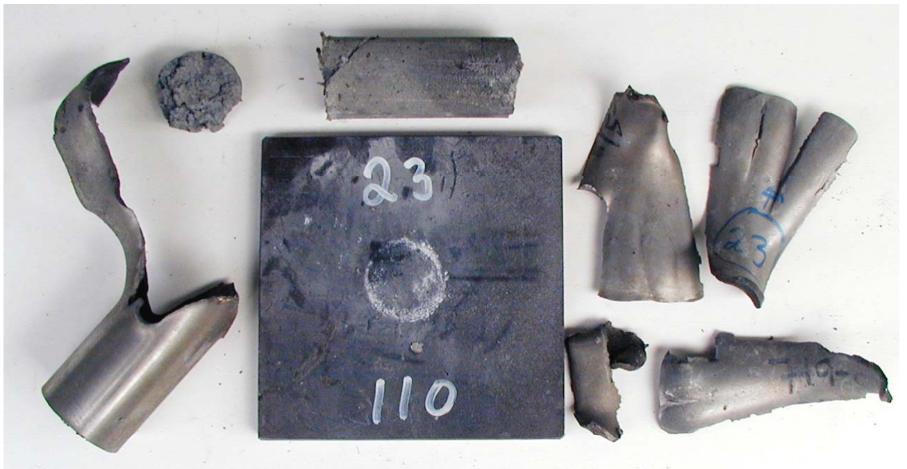
Figur 3.27 Skudd 20, rør 23 med PBXN-109 RS-RDX Ch. 719/03, 110 kort, ikke omsatt.
