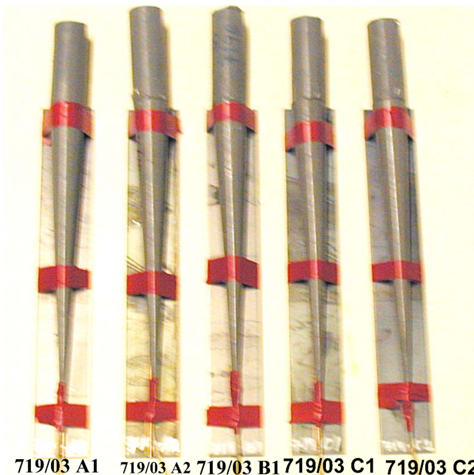
Figur 3.5 Oppsett for testlegemene benyttet til bestemmelse av kritisk diameter for RS-RDX Ch. 719/03.
