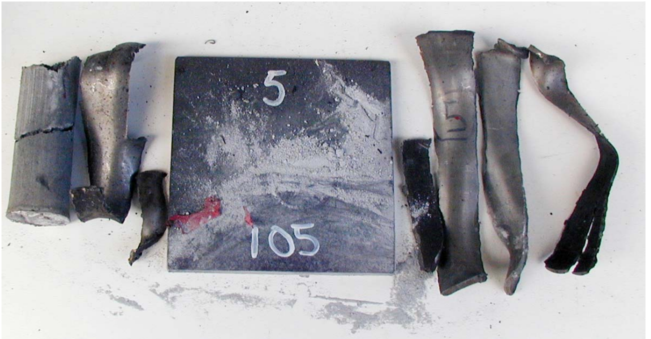
Figur 3.11 Skudd 5, rør 5 med PBXN-109 RS-RDX Ch.167/03, 105 kort, ikke omsatt.
