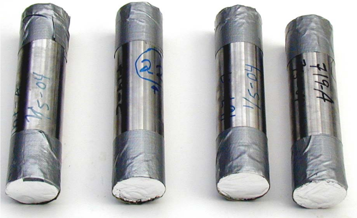
Figur 3.1 Bilde av hvordan testrørene var pakket under lagringen.
