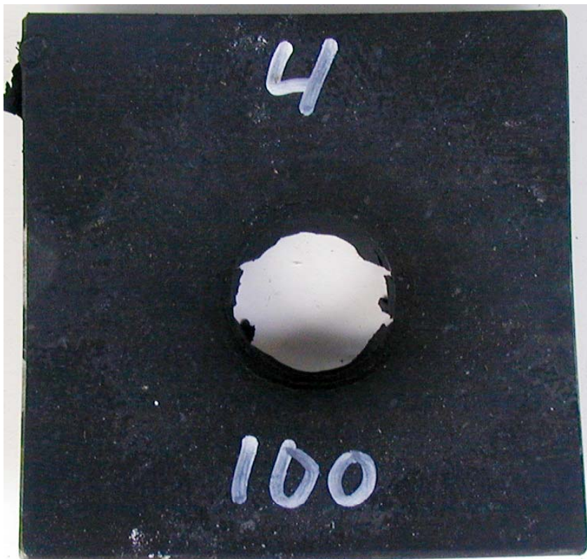
Figur 3.10 Skudd 4, rør 4 med PBXN-109 RS-RDX Ch.167/03, 100 kort, omsatt.
