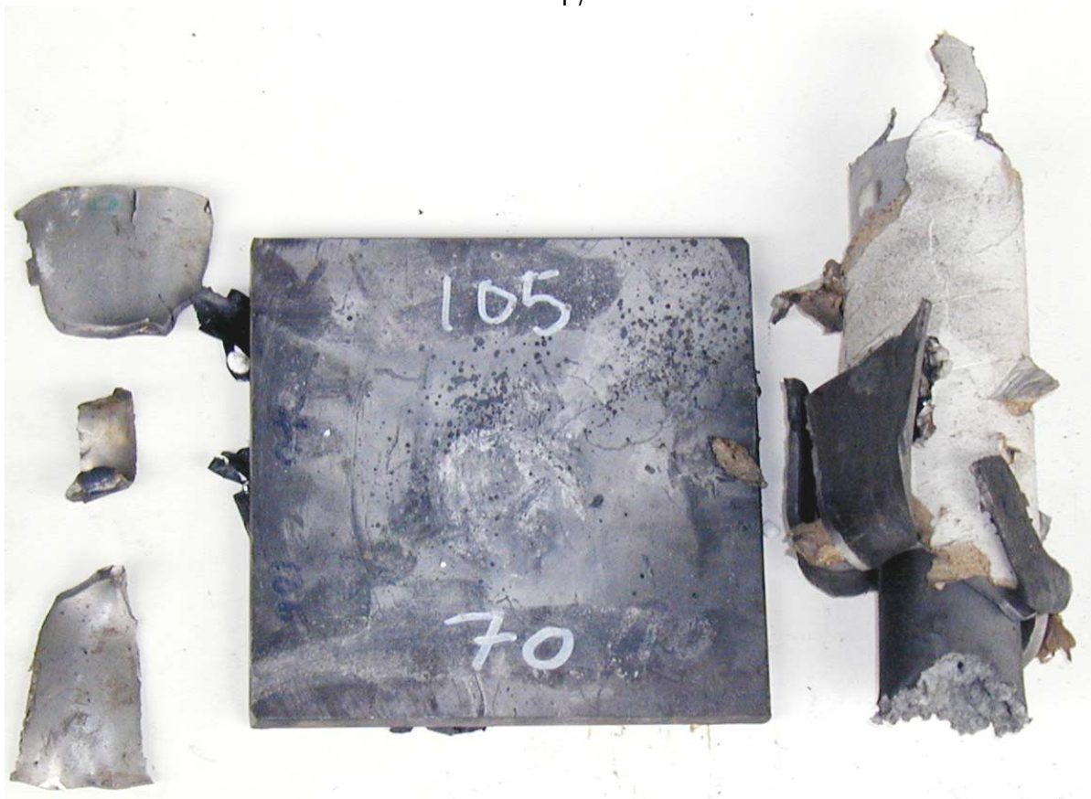
Figur 3.9 Skudd 1, rør 70 med PBXN-109 RS-RDX Ch. 167/03, 105 kort, ikke omsatt.
