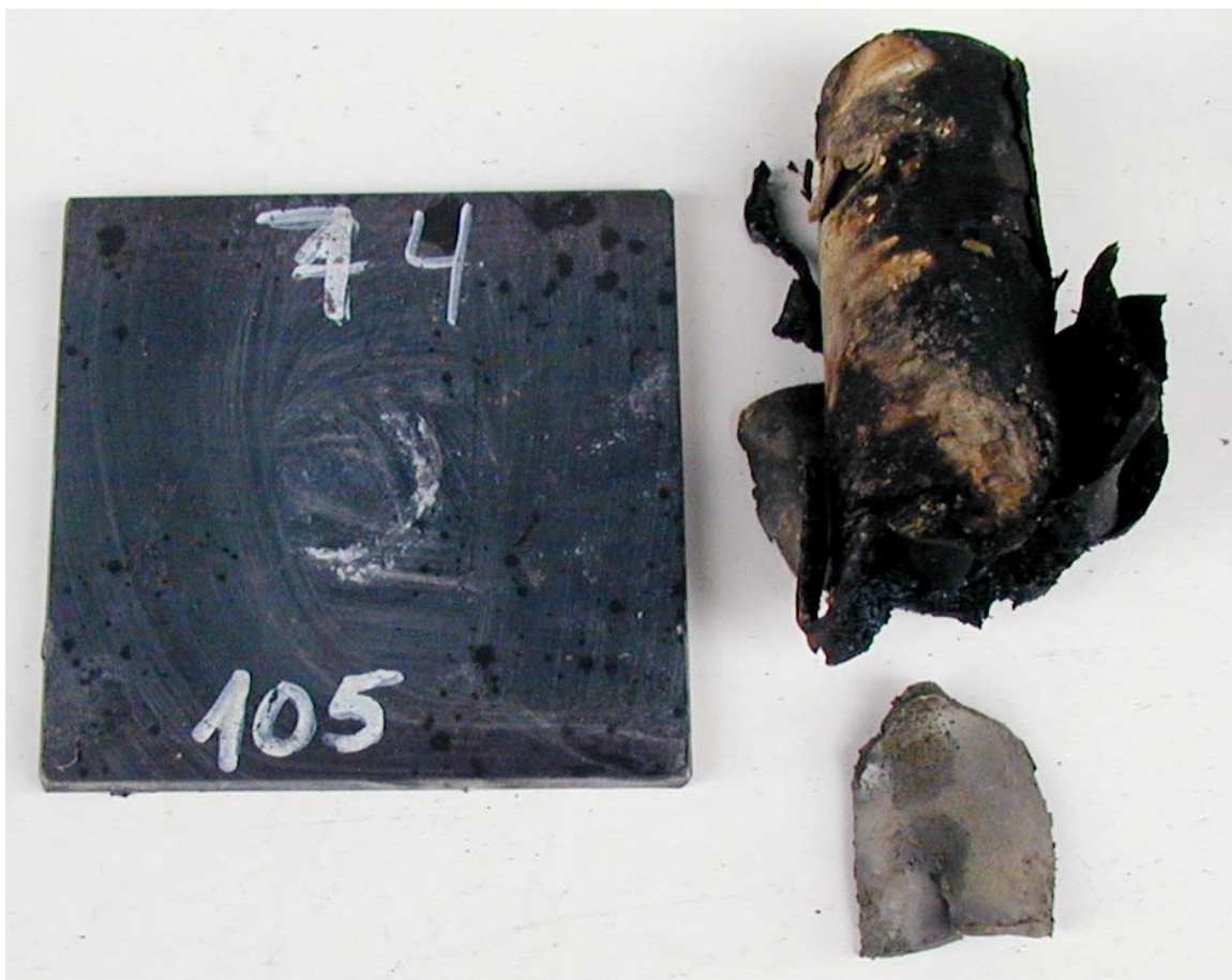
Figur 3.13 Skudd 5, rør 74 med PBXN-109 RS-RDX Ch. 167/03, 105 kort, ikke omsatt.
