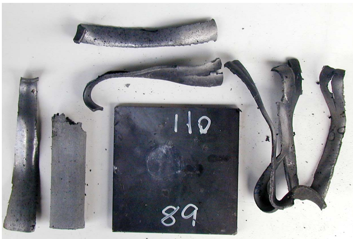
Figur 3.29 Skudd 20, rør 89 med PBXN-109 RS-RDX Ch. 719/03 110 kort, ikke omsatt.
