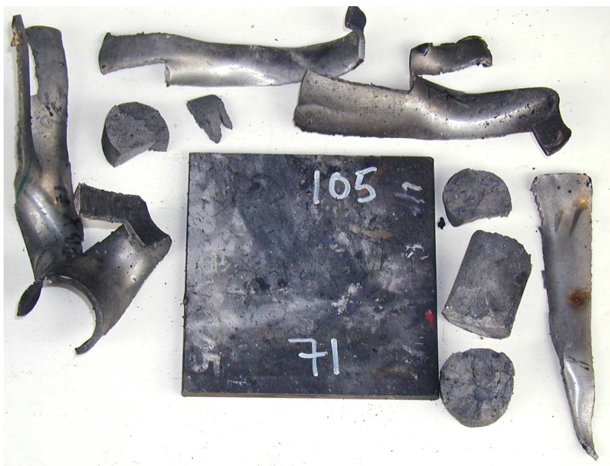
Figur 3.10 Skudd 2, rør 71 med PBXN-109 RS-RDX Ch. 167/03, 105 kort, ikke omsatt.
