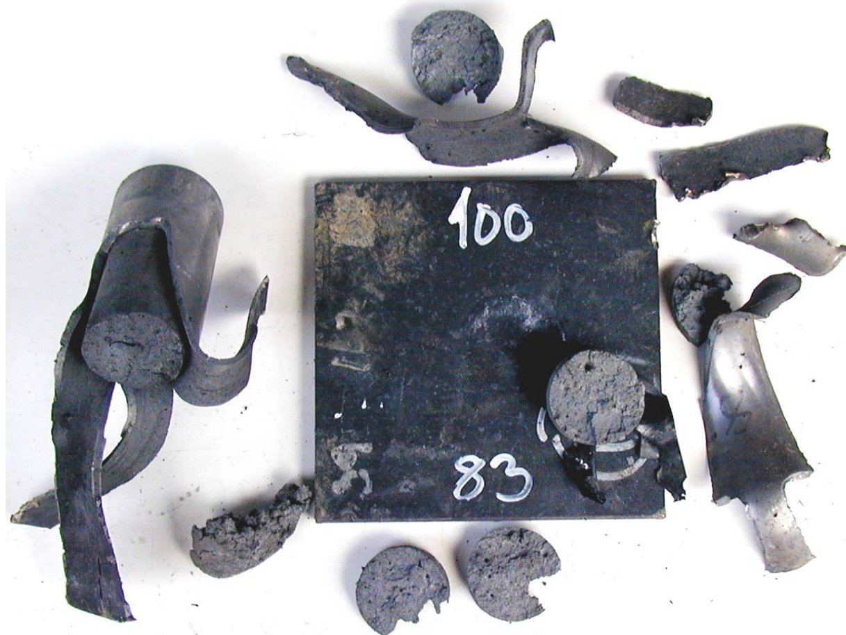
Figur 3.22 Skudd 13, rør 82 med PBXN-109 RS-RDX Ch. 719/03 105 kort, ikke omsatt.
