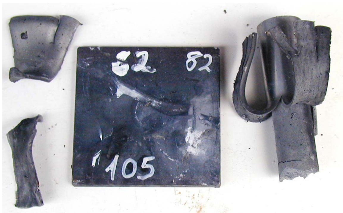
Figur 3.22 Skudd 13, rør 82 med PBXN-109 RS-RDX Ch. 719/03 105 kort, ikke omsatt.
