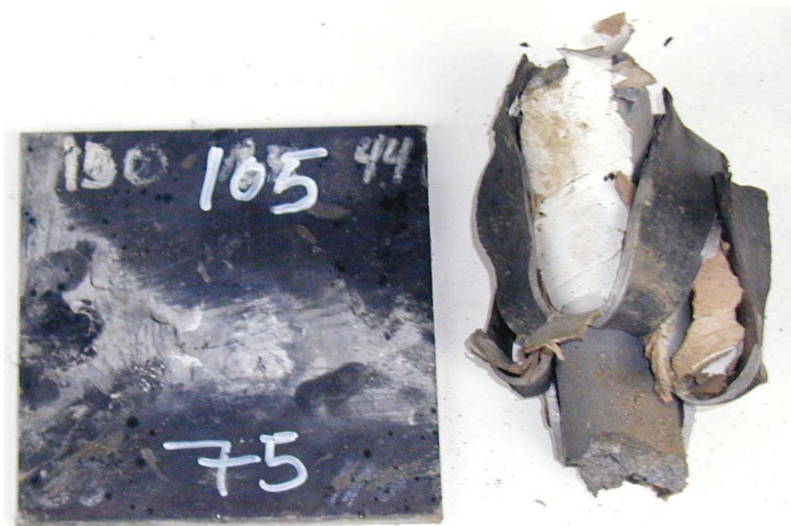
Figur 3.13 Skudd 5, rør 74 med PBXN-109 RS-RDX Ch. 167/03, 105 kort, ikke omsatt.
