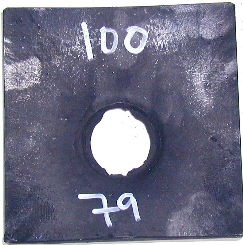
Figur 3.18 Skudd 10, rør nr. 79 med PBXN-109 RS-RDX Ch. 167/03, 100 kort, omsatt.
