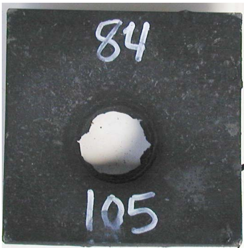
Figur 3.24 Skudd 14, rør 84 med PBXN-109 RS-RDX Ch.719/03 105 kort, omsatt.
