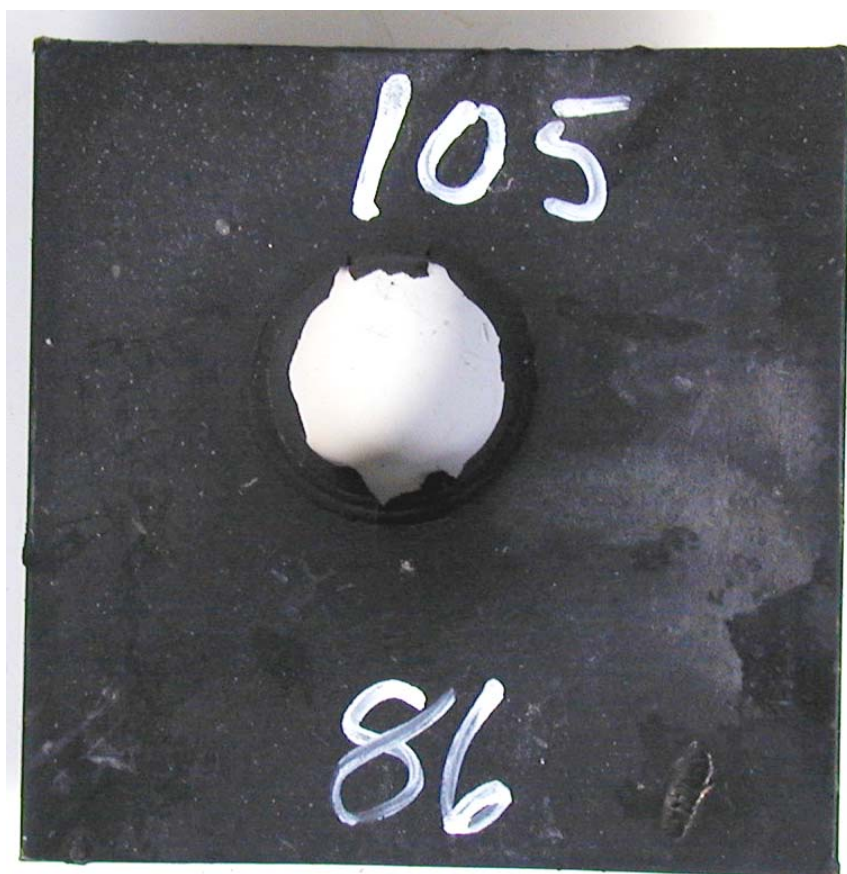
Figur 3.26 Skudd 17, rør 86 med PBXN-109 RS-RDX Ch. 719/03 105 kort, omsatt.
