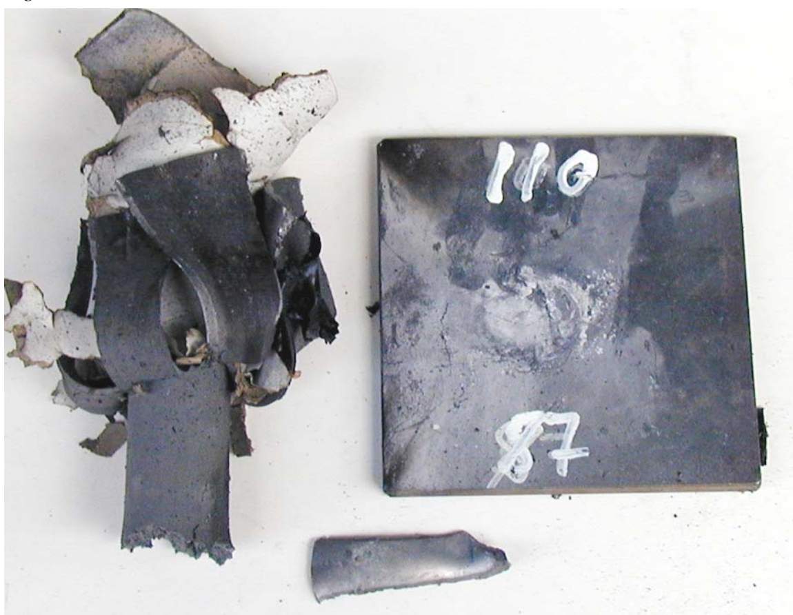
Figur 3.27 Skudd 18, rør 87 med PBXN-109 RS-RDX Ch.719/03 110 kort, ikke omsatt.
