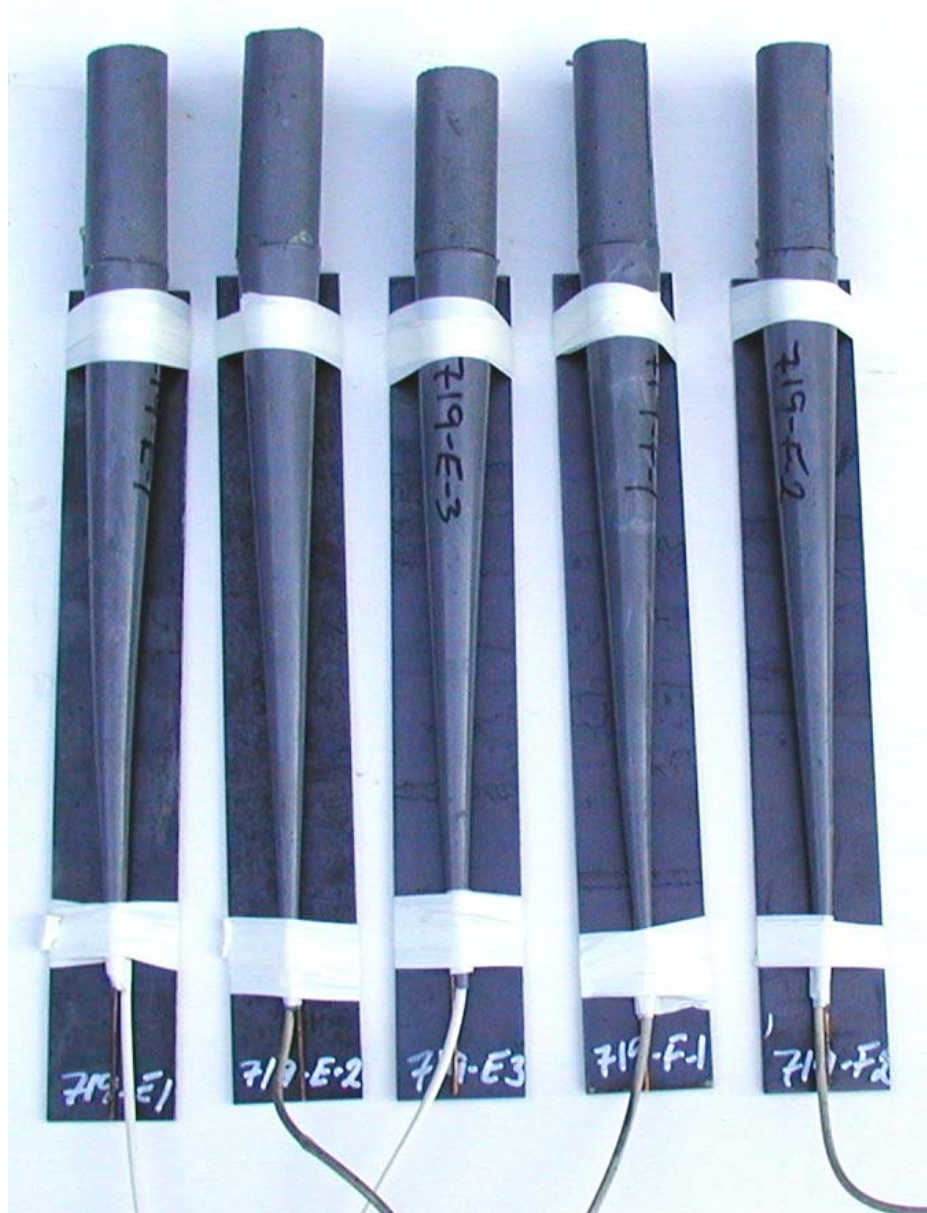
Figur 3.7 Skuddene med RS-RDX Ch. 719/03 som ble testet for bestemmelse av kritisk diameter.
