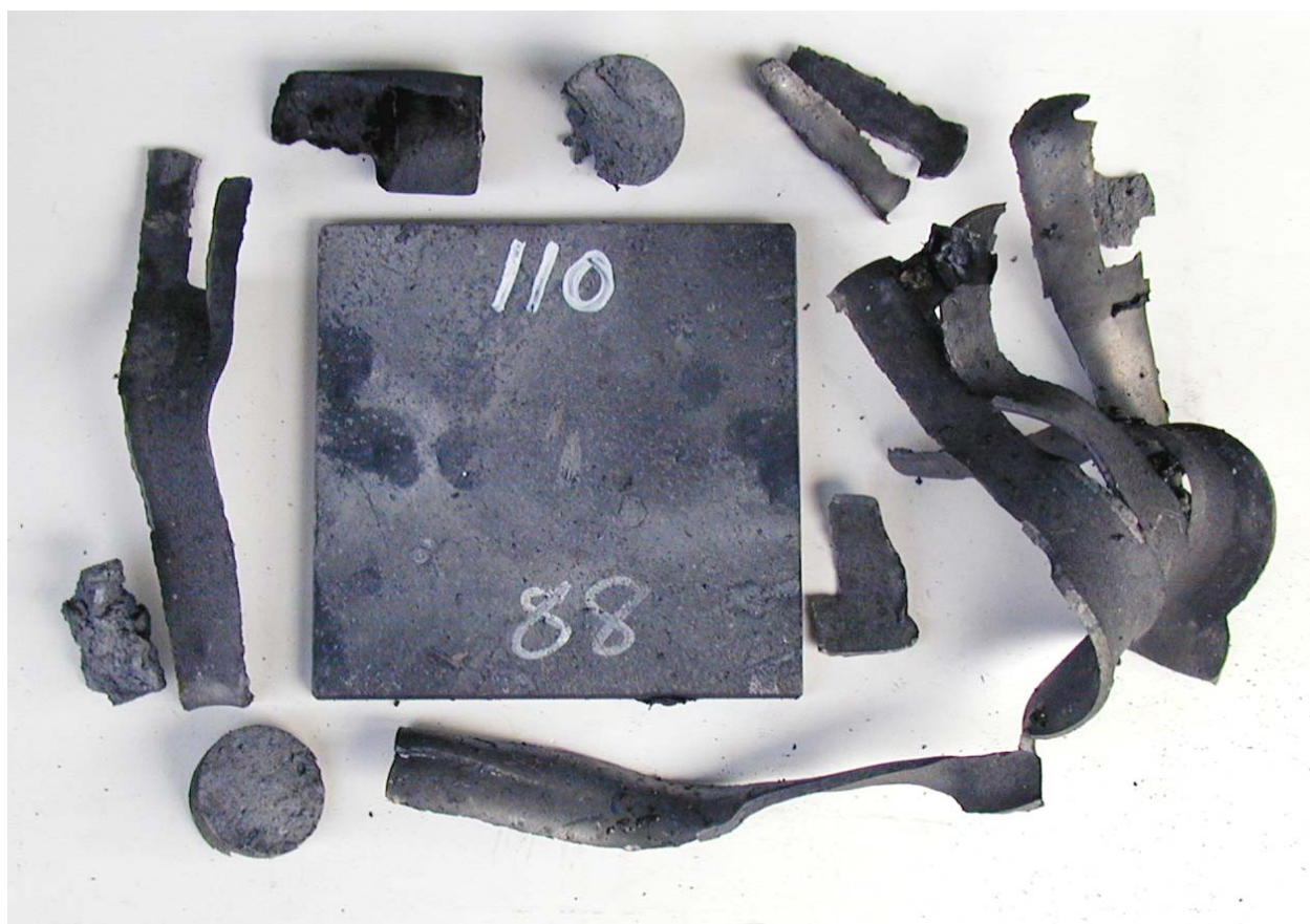
Figur 3.28 Skudd 19, rør 88 med PBXN-109 RS-RDX Ch. 719/03 110 kort ikke omsatt.
