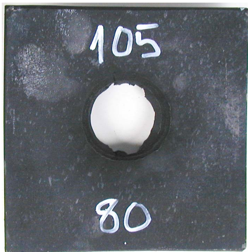
Figur 3.20 Skudd 11, rør 80 med PBXN-109 RS-RDX Ch. 719/03 105 kort, omsatt.
