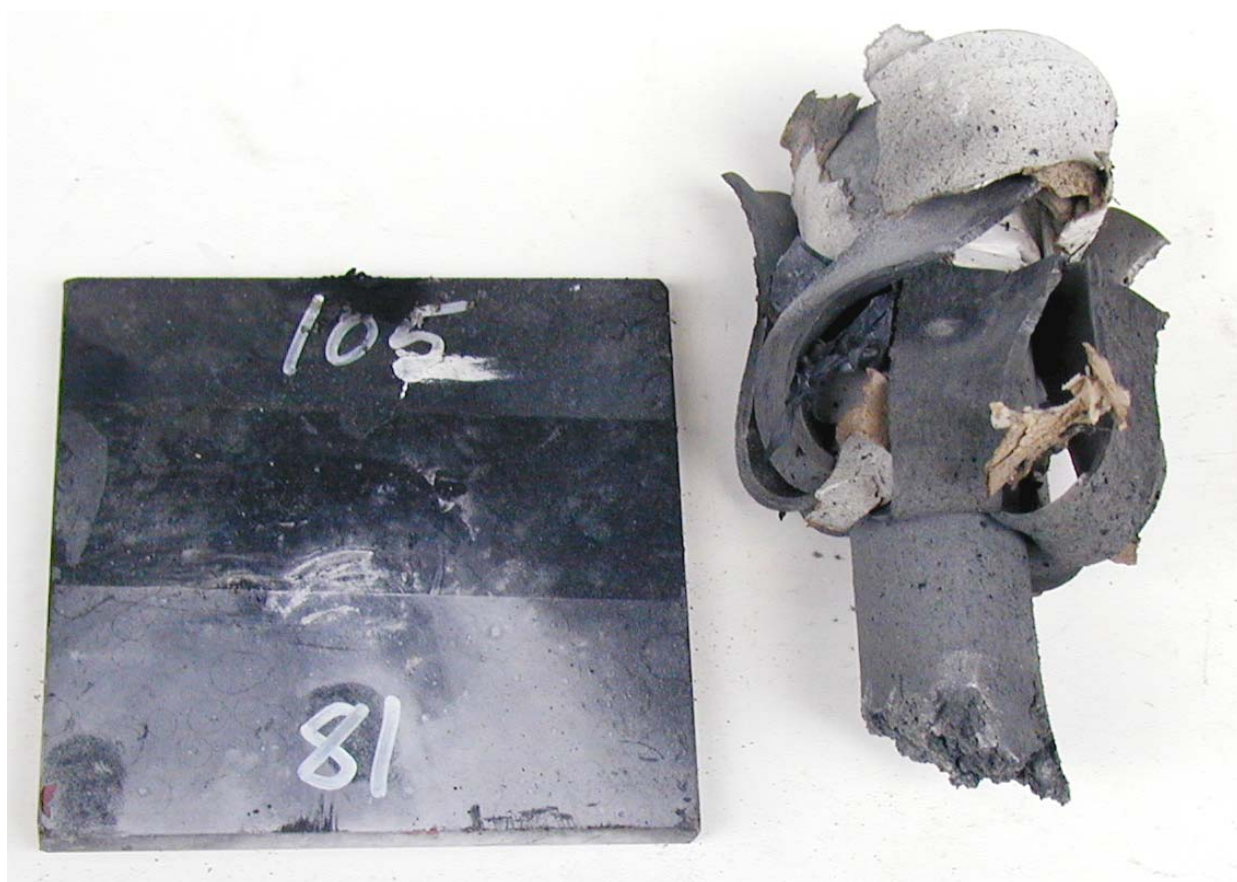
Figur 3.21 Skudd 12, rør 81 med PBXN-109 RS-RDX Ch. 719/03 105 kort, ikke omsatt.
