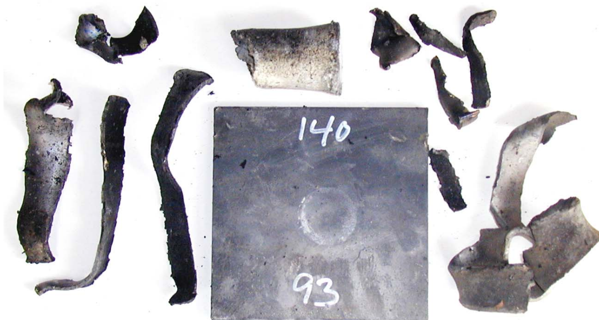
Figur 3.5 Skudd 3, rør 93 med PBXN-110, 140 kort, ikke omsatt.
