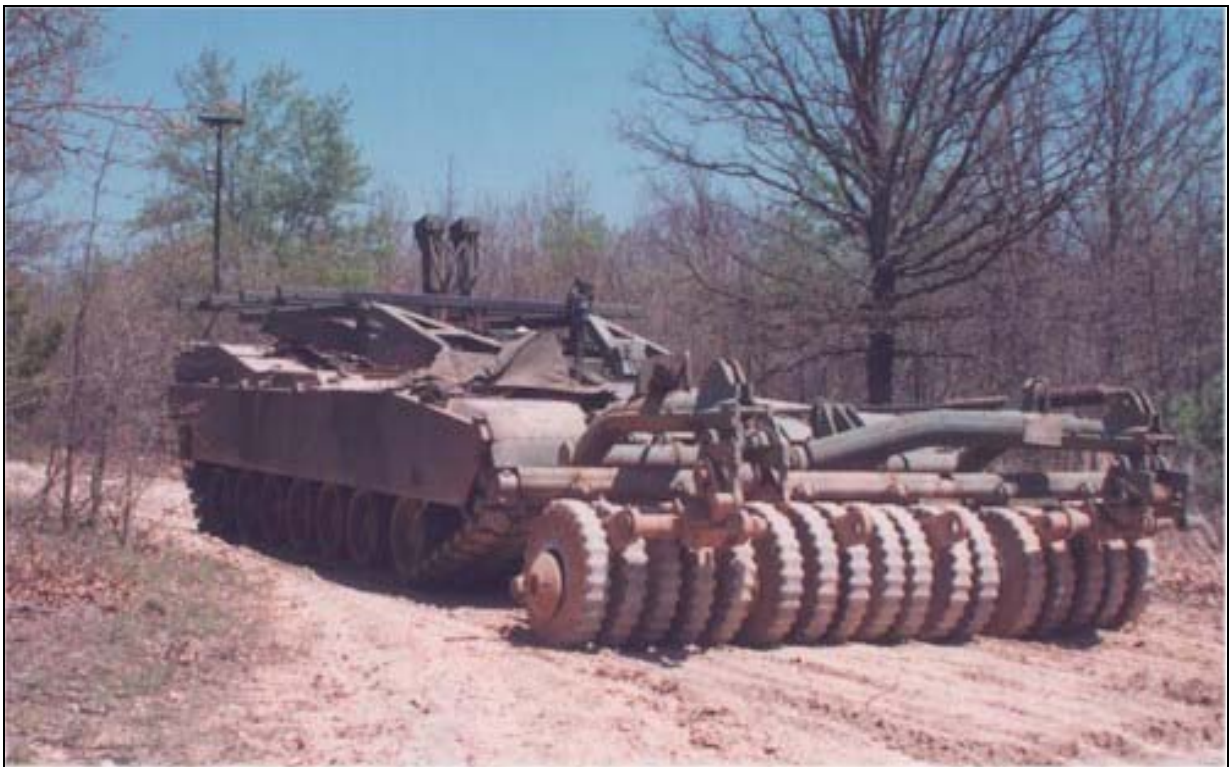
Figur 3.13 M60 Panther er en M60 Patton stridsvogn som er spesialtilpasset til mineryddingsoppdrag. Tårnet er fjernet, og ruller for fjerning av miner er montert i fronten. Den er utstyrt med fjernstyring slik at den kan opereres fra trygg distanse til minefeltet
