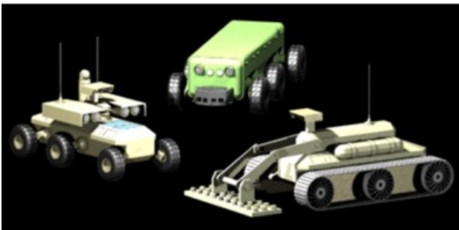
Figur 3.10 MULE fins i tre ulike varianter; transport, minerydding og lett stridskjøretøy
