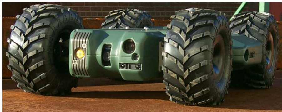
Figur 1.1 Det har de siste par årene vært en rask utvikling av ubemannede bakkekjøretøy med ulike sensorer. Spesielt er utviklingen på sensorsiden stor. Bildet viser Dragon Runner, et lett bærbart kjøretøy (ca. 4,5 kg) som blir benyttet av USMC i Irak og Afghanistan. UGV-en kan bære ulike typer sensorer, f.eks. for visuell inspeksjon eller sniffing etter eksplosiver
