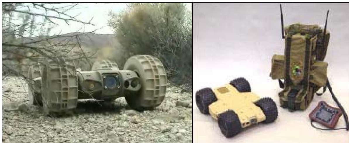
Figur 3.4 Dragon Runner er så liten og lett at den kan bæres av en soldat i en ryggsekk. Bildet til venstre viser en Dragon Runner i aksjon
