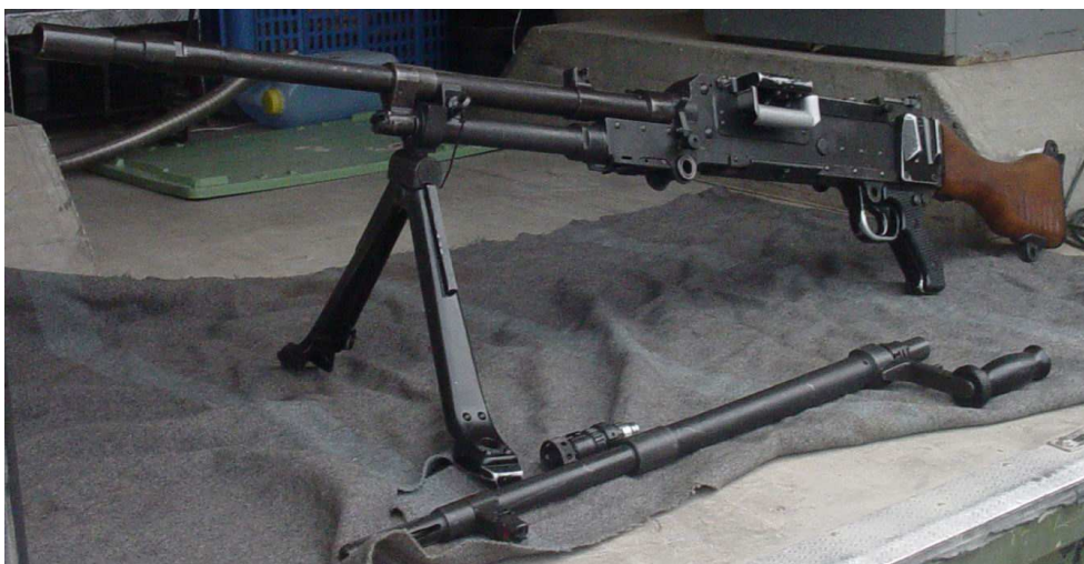
Figur 3.1 FN MAG med to forskjellige løp. Det er coax-løpet som er montert på våpenet.
