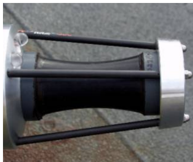
Figur 5.5 Eksempel på sendertransducer for akustisk kommunikasjon. Diameter ca 10 cm
