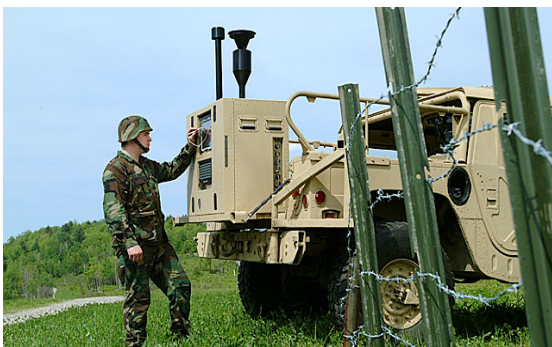
Figur 8.2. Det amerikanske JBPDS systemet som skal overta for BIDS . Bildet viser instrumentet plassert bak på en Humvee (A) og JBPDS integrert i BIDS (B) (foto: http://www.gdatp.com/ ).
