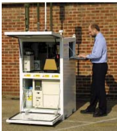
Figur 8.5. NBCerberus er et fleksibelt system utviklet av Smiths Detection. Systemet benytter flere av de samme analysemodulene som er integrert i IBDS (foto: http://trace.smithsdetection.com/ ).
