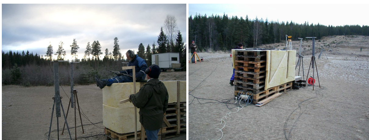
Figur 4.2 Oversikt over målerne av typen PCB 137A23, nær våpenet. En niveleringskikkert ble brukt til å måle opp posisjonene til sensorene relativt munningen på våpenet.
