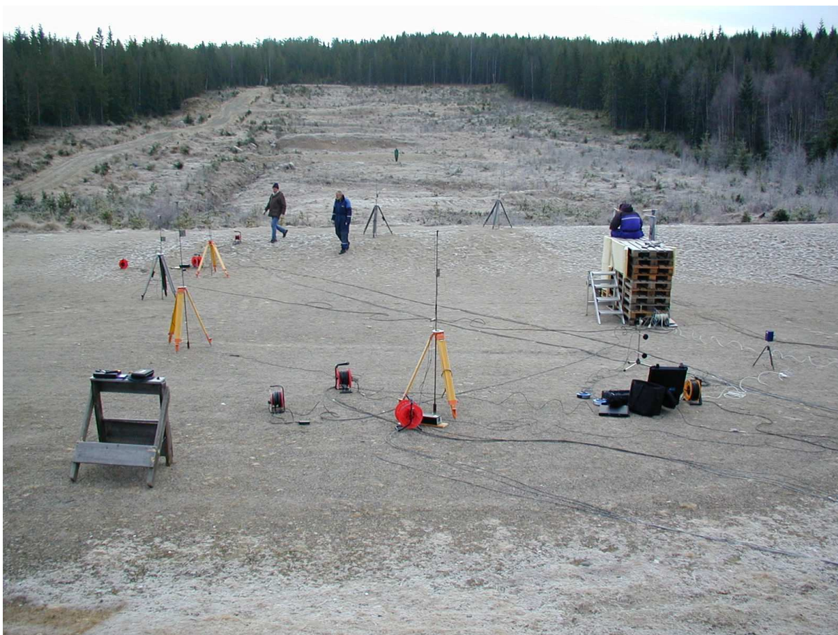
Figur 4.1 Oversiktsbilde av standplassen. Sensorer i 7 retninger på 10 m. Skytteren sitter på pallene i sentrum av halvsirkelen. Målet er figuren som skimtes lenger fremme. De to Norsonic-121 målerne står i venstre hjørne av feltet ca. 300 m fremme, og 100 m fremme på venstre side.
