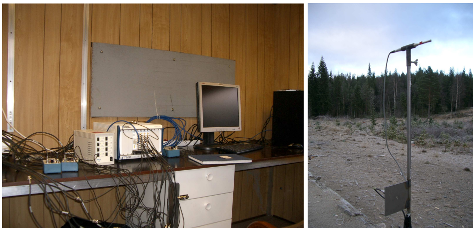
Figur 5.3 Venstre: Datainnsamlingsutstyret. Fra venstre på bildet: To PCB batteridrevne forsterkere, en 8-kanals PCB forsterker, PXI-chassiet, PC med kort for å kommunisere med PXI-chassiet. Høyre: Stativ for sensorer på 10 m. Øverst mikrofon fra Brüel & Kjær. Nederst sensor av typen PCB 106B plassert i en plate.
