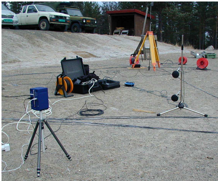
Figur 4.3 Oppsett for måling av bakkeimpedans, med en høytaler og to mikrofoner.
