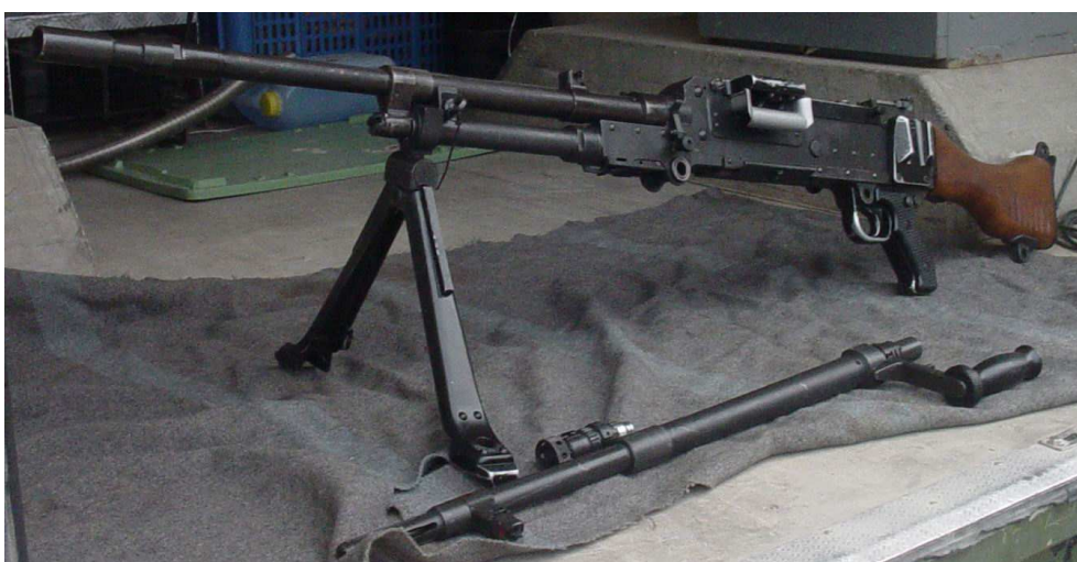
Figur 3.12 FN MAG med to forskjellige løp. Det er coax-løpet som er montert på våpenet.
