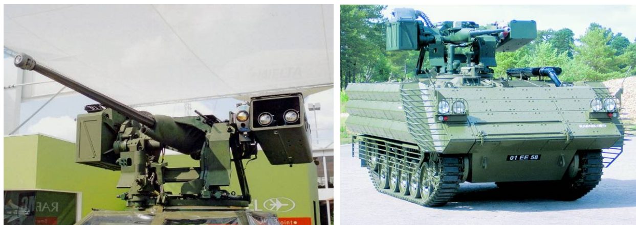
Figur 3-4 Rafaels Samson RCWS 30 våpenstasjon med 30 mm kanon og Spike-LR missillauncher. Til høyre er våpenstasjonen montert på en britisk FV432 PPK.
