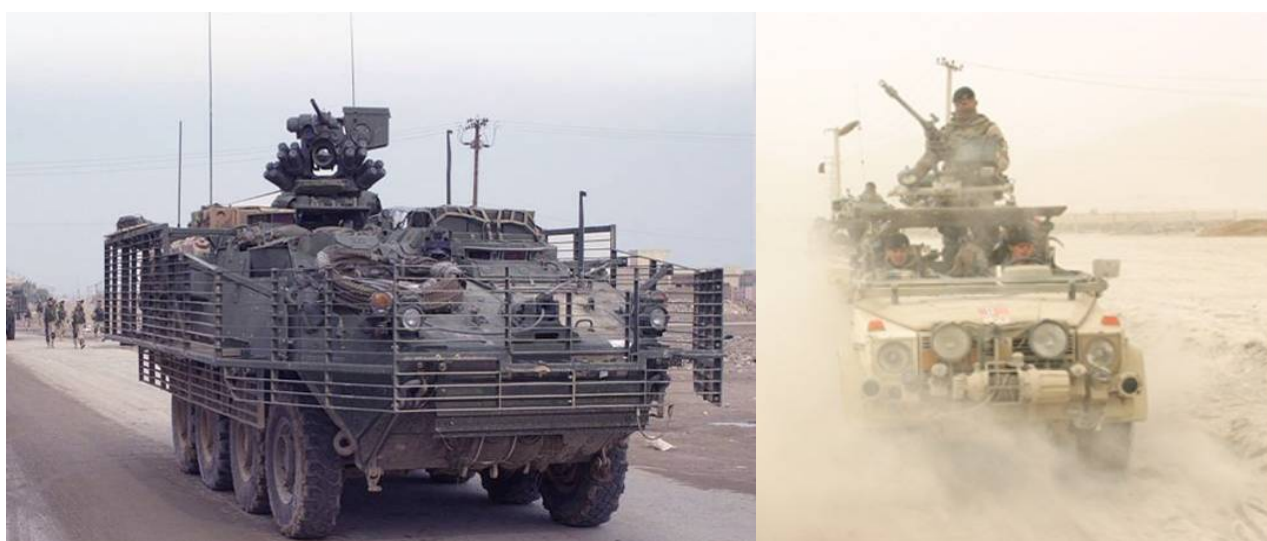
Figur 4-2 Illustrasjon av sårbarheten til en patrulje basert på tradisjonell bevæpning. Ved å utstyre kjøretøyet med en våpenstasjon, og dermed flytte skytter/observatør på innsiden, reduseres sårbarheten betydelig
