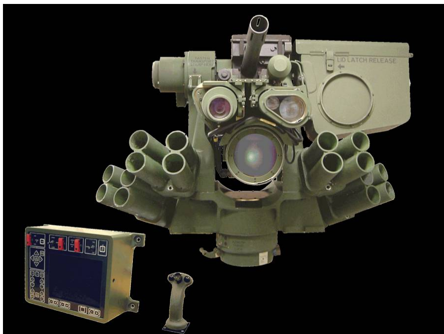
Figur 3-2 Kongsberg Protector M 151 med 40 mm AGK og operatørkonsoll. Ammunisjonskassen til høyre på bildet
