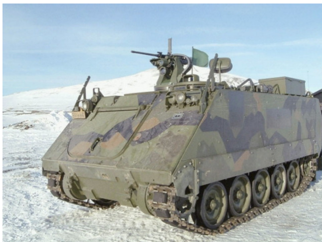
Figur 8-1 Eksempel på fjernstyrt våpenstasjon i Forsvaret i dag: Kongsberg/Vinghøg AMRWS med 12,7 mm mitraljose montert på NM 221
