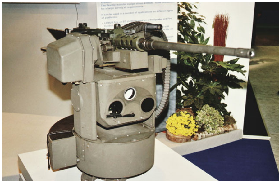
Figur 3-5 Bofors Lemur W våpenstasjon med 12,7 mm mitraljøse
