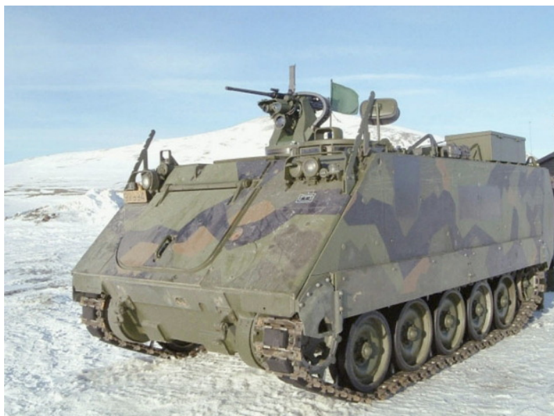
Figur 2-1 Kongsberg/Vinghøg AMRWS med 12,7 mm mitraljøse montert på NM 221.
