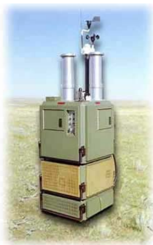
Figur 8.4. 4WARN CB System V.3 er et automatisk integrert detektorsystem for B- og C-trusselstoffer utviklet av det kanadiske forsvaret i samarbeid med General Dynamics (foto: http://www.suffield.drdc-rddc.gc.ca/ ).
