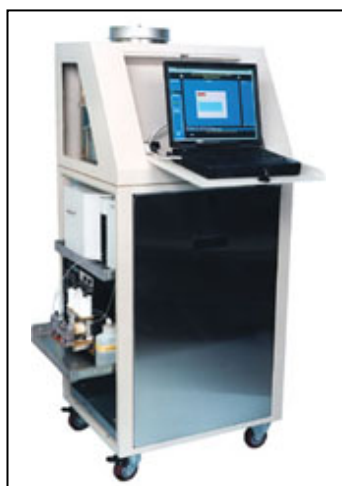
Figur 8.6. Et integrert B-deteksjonssystem for sivil bruk. Autonomous Pathogen Detection System APDS, utviklet av Lawrence Livermore National Laboratory, for analyse av luftprøver ved hjelp av PCR og immunologiske analyser (foto: http://www.llnl.gov ).
