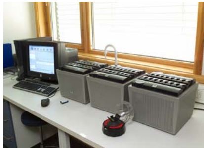
Figur 4.9. Real-time PCR instrumentene ved FFI; LightCycler (A) og SmartCycler (B) (foto: FFI).
