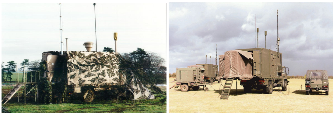
Figur 8.3. IBDS er et helautomatisk integrert biologiske detektorsystem benyttet i det britiske forsvaret (foto: http://www8.janes.com ).
