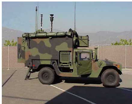
Figur 8.2. Det amerikanske JBPDS systemet som skal overta for BIDS . Bildet viser instrumentet plassert bak på en Humvee (A) og JBPDS integrert i BIDS (B) (foto: http://www.gdatp.com/ ).
