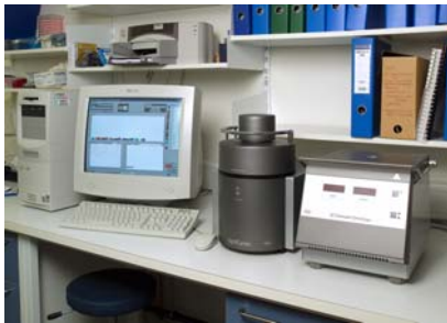
Figur 4.9. Real-time PCR instrumentene ved FFI; LightCycler (A) og SmartCycler (B) (foto: FFI).
