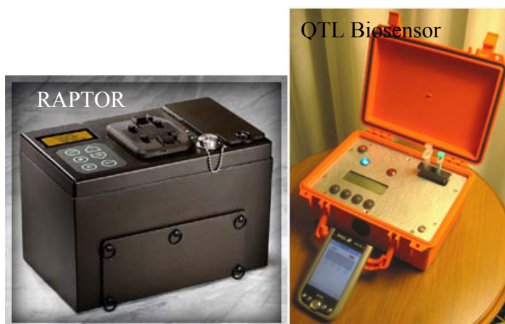
Figur 7.2. Bærbare biosensorer egnet for felt bruk i forsvaret; RAPTOR og QTL Biosensor fra hhv Research International og QTL Biosystems (foto: hhv http://www.resrchintl.com og http://www.qtlbio.com/ ).
