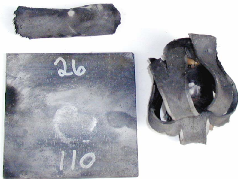
Figur 3.7 Skudd 5, rør 26 med PBXN-109 aldret i 6 mnd ved 60°C, 110 kort, ikke omsatt.
