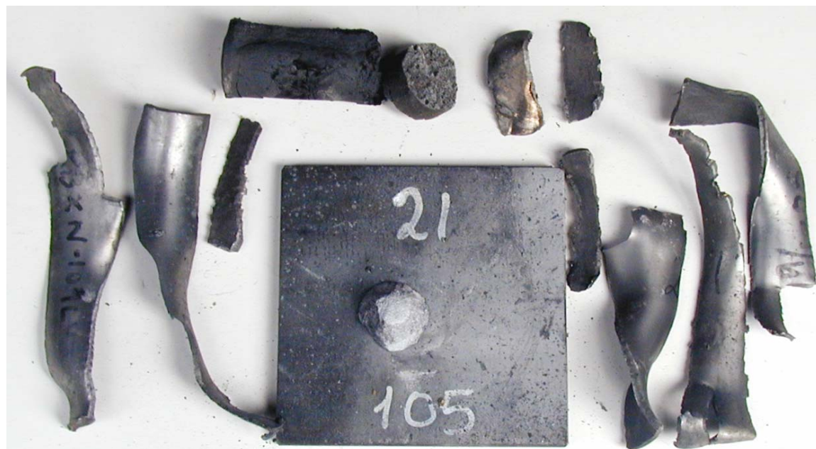
Figur 3.11 Skudd 9, rør 22 med PBXN-109 aldret i 6 mnd ved 60°C, 105 kort, ikke omsatt.
