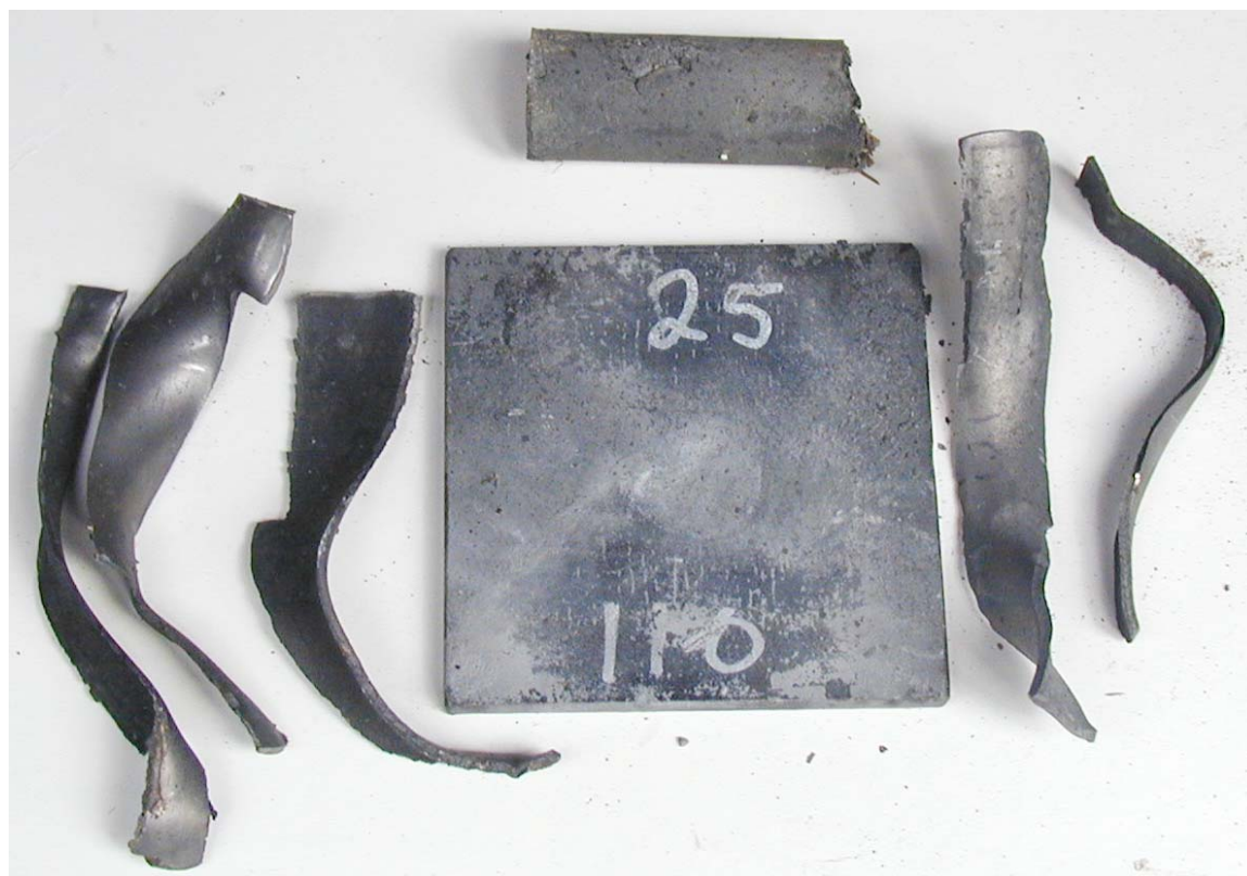
Figur 3.8 Skudd 6, rør 25 med PBXN-109 aldret i 6 mnd ved 60°C, 110 kort, ikke omsatt.
