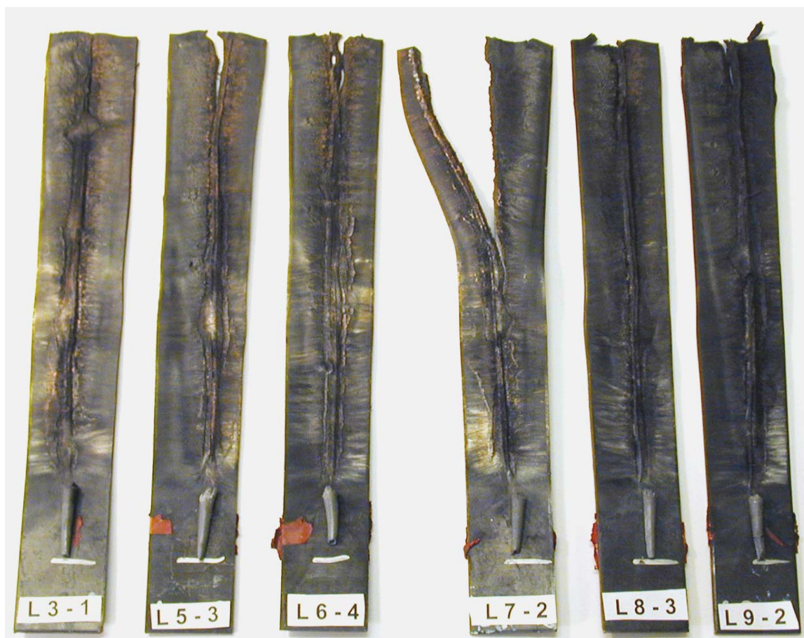
Figur 3.2 Vitneplater med rester av sprengstoffkon fra bestemmelsen av kritisk diameter.
