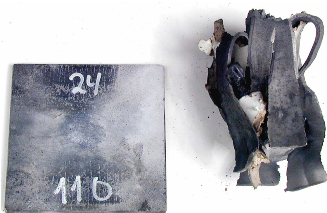
Figur 3.9 Skudd 7, rør 24 med PBXN-109 aldret i 6 mnd ved 60°C, 110 kort, ikke omsatt.
