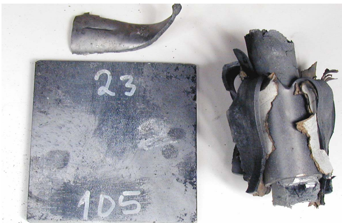
Figur 3.9 Skudd 7, rør 24 med PBXN-109 aldret i 6 mnd ved 60°C, 110 kort, ikke omsatt.
