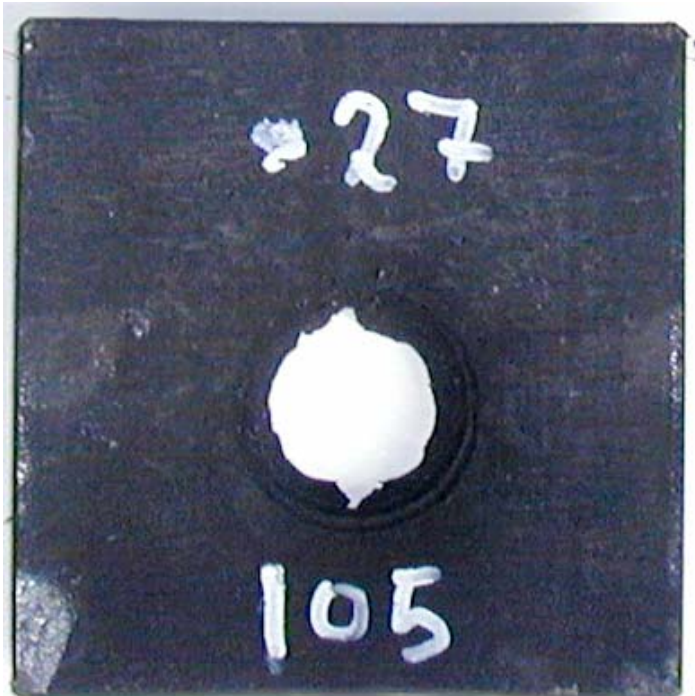
Figur 3.6 Skudd 4, rør 27 med PBXN-109 aldret i 6 mnd ved 60°C, 105 kort, omsatt.
