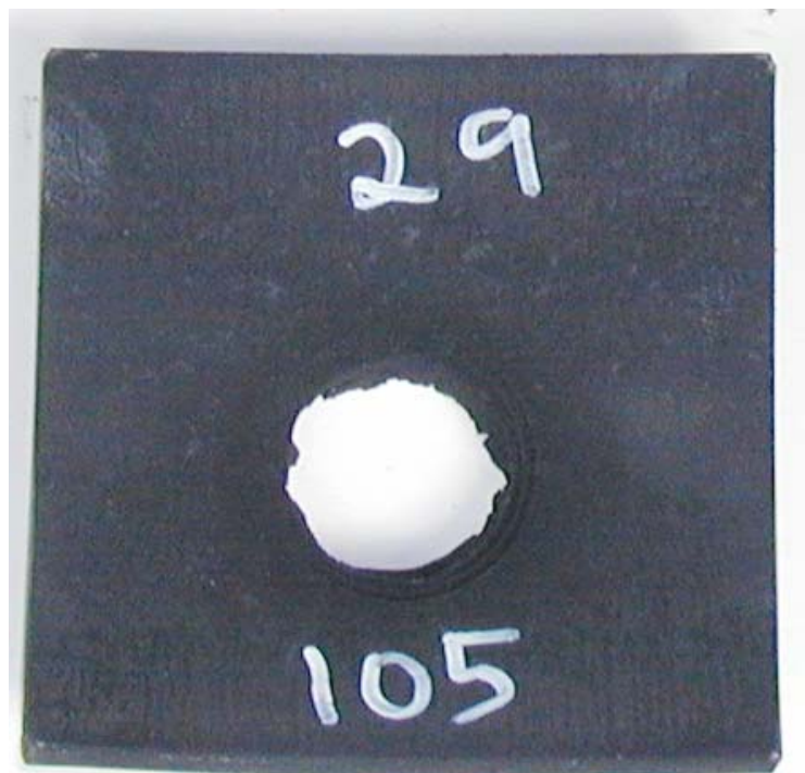
Figur 3.4 Skudd 2, rør 29 med PBXN-109 aldret i 6 mnd ved 60°C, 105 kort, omsatt.
