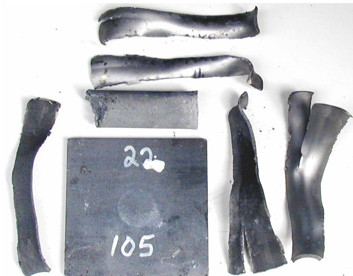
Figur 3.11 Skudd 9, rør 22 med PBXN-109 aldret i 6 mnd ved 60°C, 105 kort, ikke omsatt.
