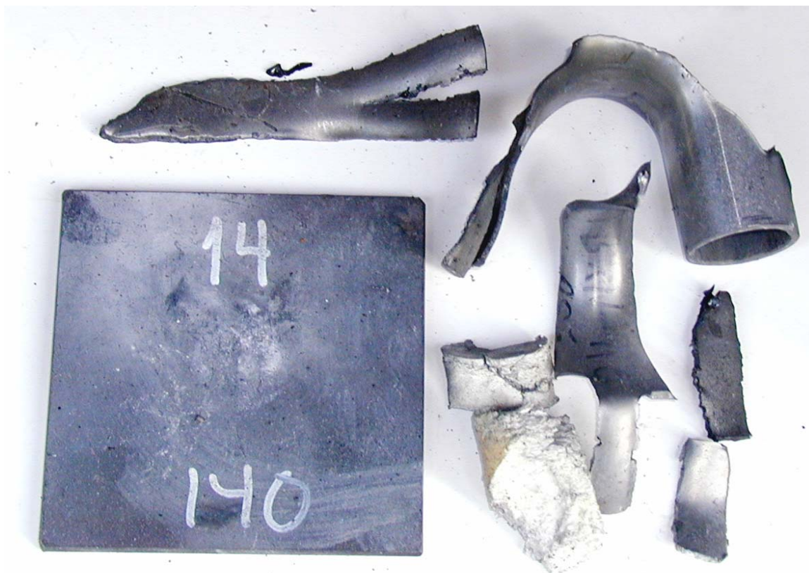
Figur 3.11 Skudd 7, rør 14 med PBXN-110 med RSE blanding, 140 kort, ikke omsatt.
