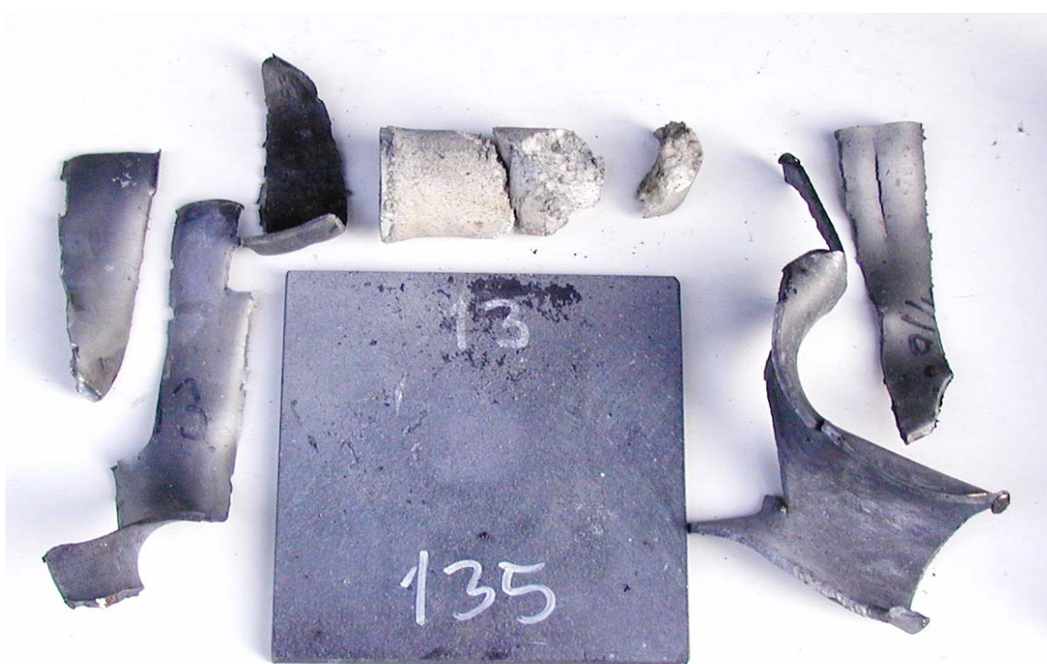
Figur 3.11 Skudd 7, rør 14 med PBXN-110 med RSE blanding, 140 kort, ikke omsatt.
