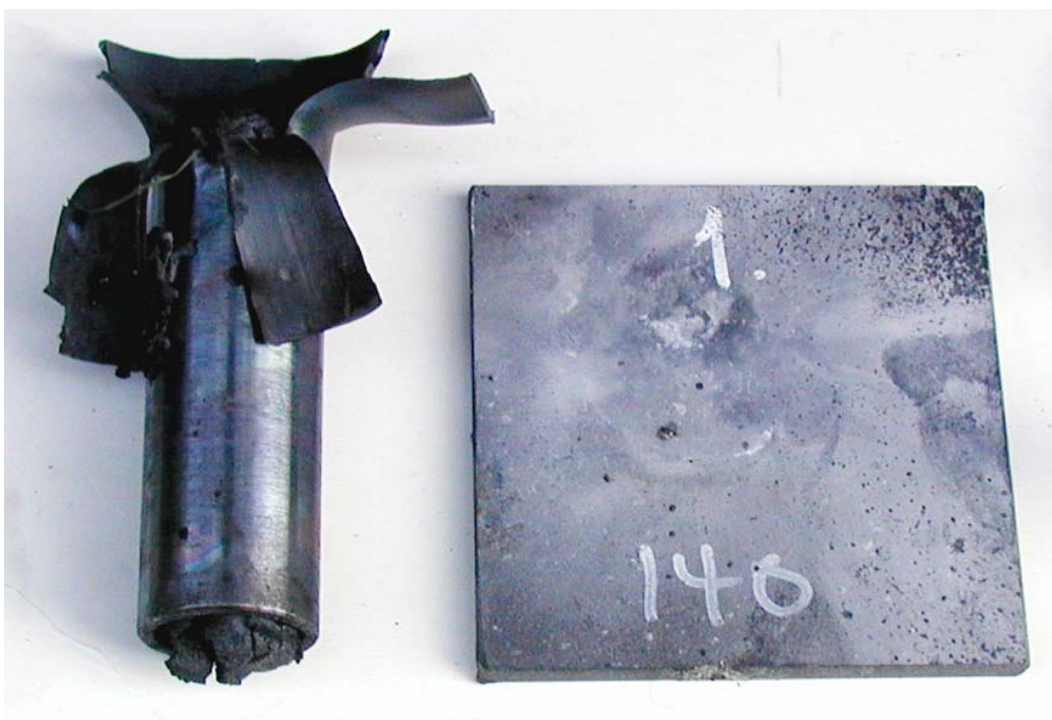
Figur 3.16 Skudd 11, rør 1 med PBXN-110 RSC blanding, 140 kort, ikke omsatt.
