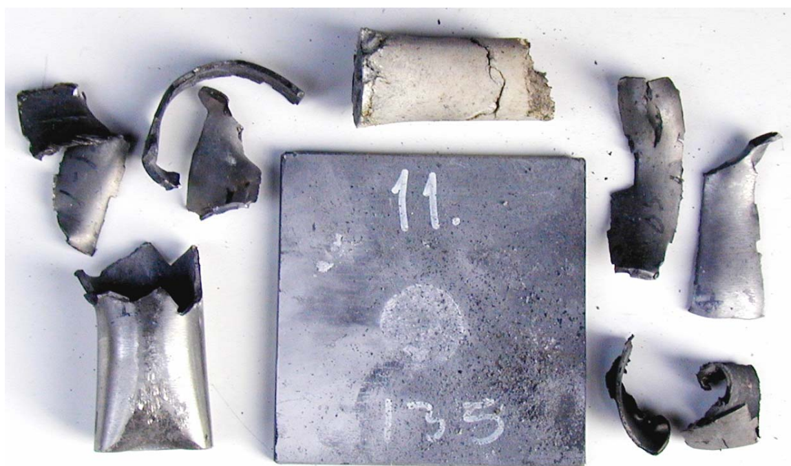
Figur 3.14 Skudd 10, rør 11 med PBXN-110 RSE blanding, 135 kort, ikke omsatt.
