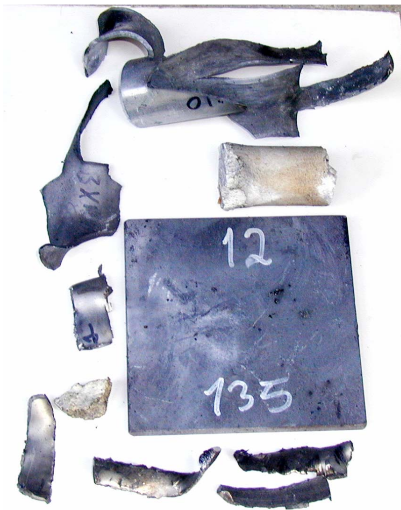
Figur 3.13 Skudd 9, rør 12 med PBXN-110 RSE blanding, 135 kort, ikke omsatt.
