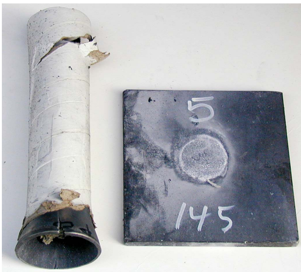
Figur 3.20 Skudd 15, rør 5 med PBXN-110 RSC blanding, 145 kort, ikke omsatt.
