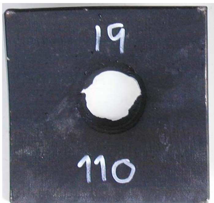
Figur 3.6 Skudd 2, rør 19 med PBXN-110 med RSF blanding, 110 kort, omsatt.
