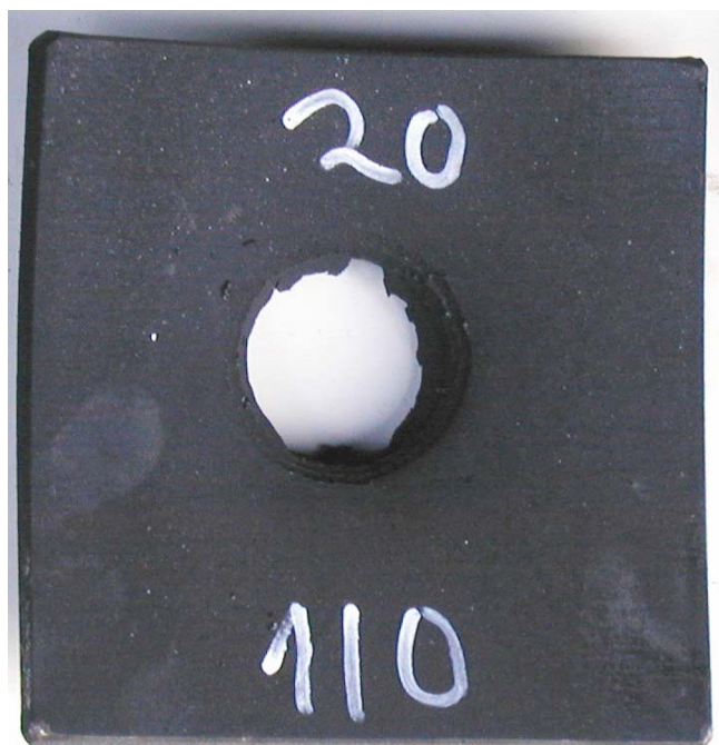
Figur 3.5 Skudd 1, rør 20 med PBXN-110 RSF blanding, 110 kort, omsatt.
