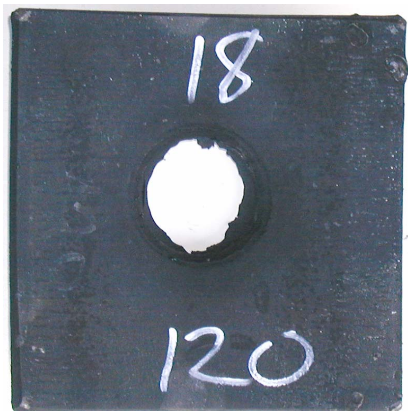
Figur 3.7 Skudd 3, rør 18 med PBXN-110 RSF blanding, 120 kort, omsatt.
