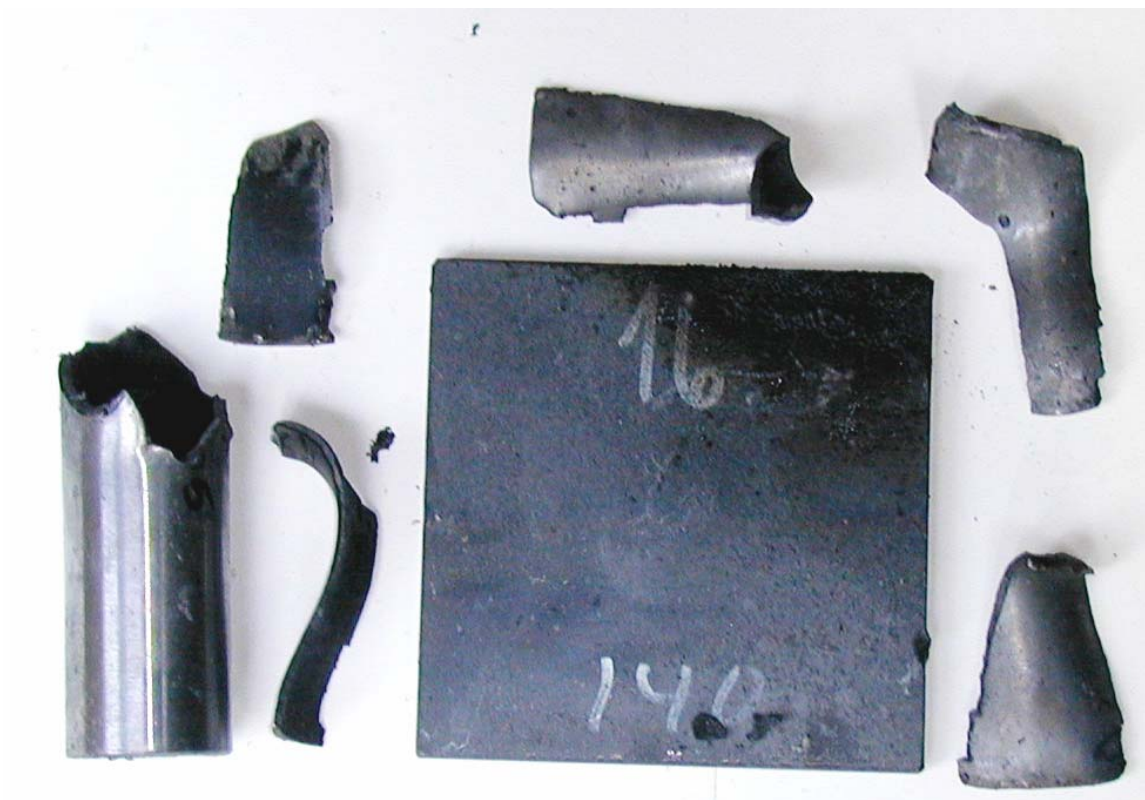
Figur 3.9 Skudd 5, rør 16 med PBXN-110 RSF blanding, 140 kort, ikke omsatt.
