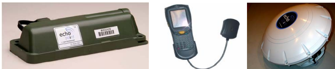
Figur 6.1 Aktiv RFID-brikke, håndholdt og stasjonær avleser
