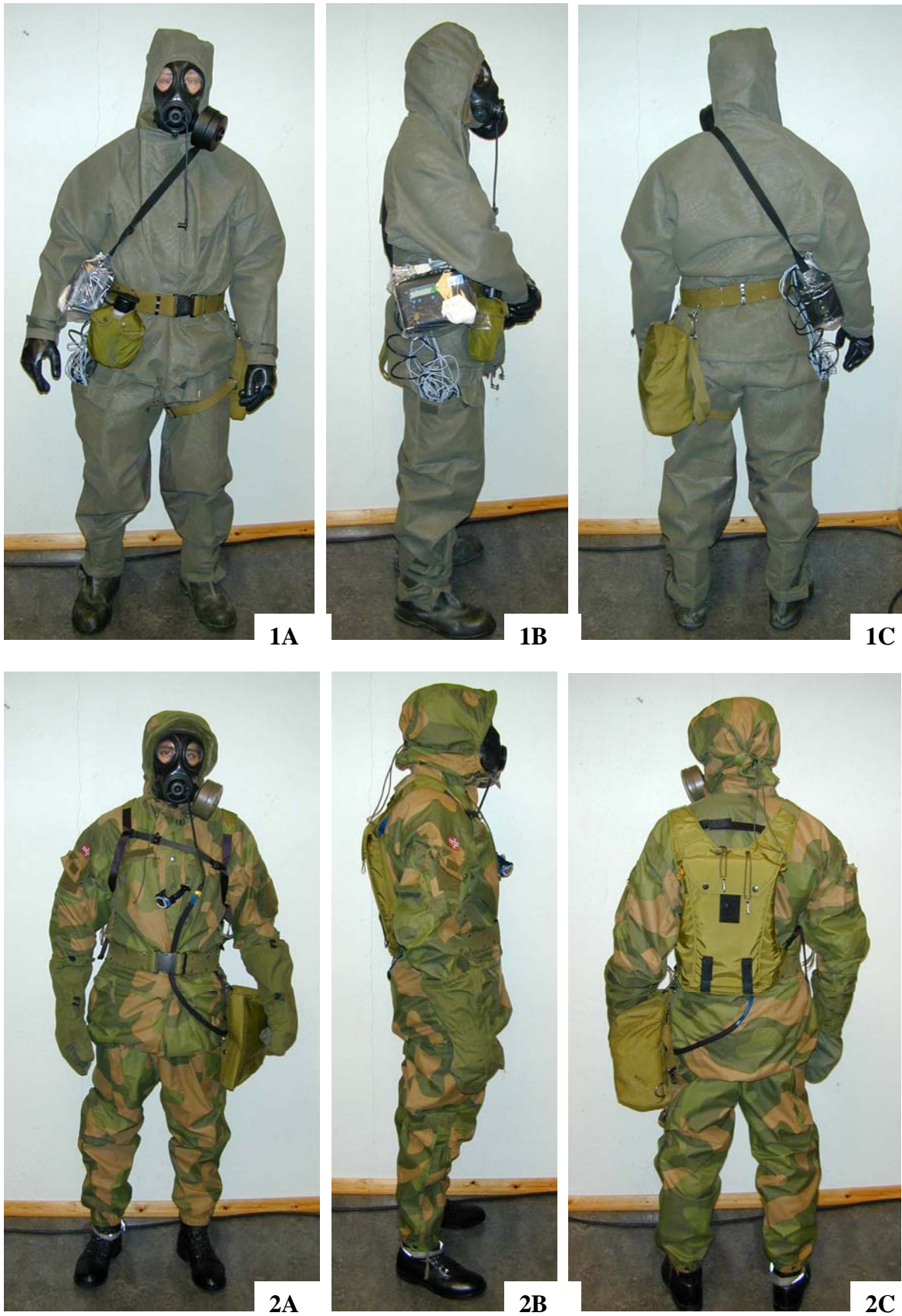
Figur 3.4 Bekledningen og utrustning som ble benyttet dag 2. Forsvarets nåværende vernedrakt NM143 (1) og ny NORMANS vernedrakt med integrert C-beskyttelse i form av et C-innerfôr (2). Med vernemaske og alle ventilasjonsåpningene i bekleddingen lukket.
