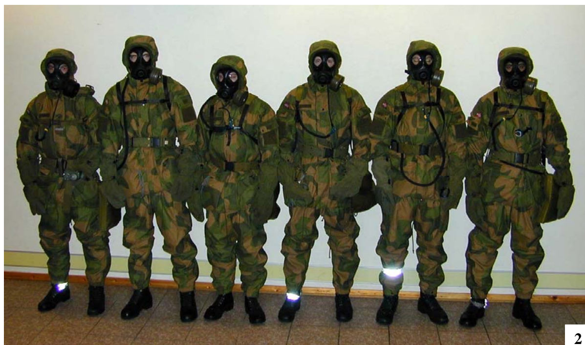
Figur 4.12 Forsøkspersonene er klare til å starte første forsøksøkt dag 2. Gruppe 2 med Forsvarets nåværende vernedrakt NM143 (1) og gruppe 1 med ny NORMANS vernedrakt med integrert C-beskyttelse i form av et C-fôr (2). Forsøkene er utført med vernemaske og alle ventilasjonsåpninger lukket under hele forsøksperioden. Figur 3.3 viser et mer detaljert bilde av de to vernedraktene.
