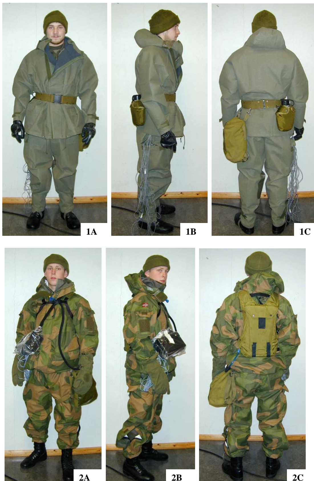
Figur 3.3 Bekledningen og utrustning som ble benyttet dag 1. Forsvarets nåværende vernedrakt NM143 (1) og ny NORMANS vernedrakt med integrert C-beskyttelse i form av et C-innerfôr (2). Alle ventilasjonsåpningene i bekleddingen er åpnet.
