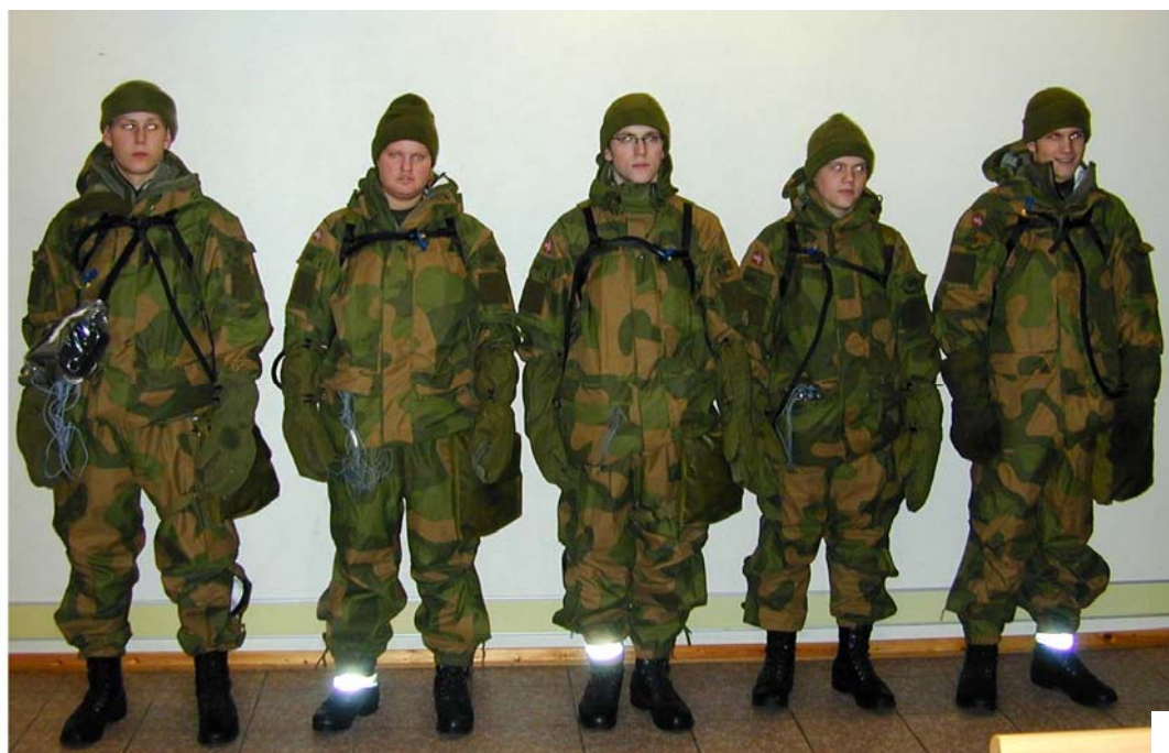
Figur 4.1 Forsøkspersonene er klare til å starte andre forsøksøkt dag 1. Gruppe 1 med Forsvarets nåværende vernedrakt NM143 (1) og gruppe 2 med ny NORMANS vernedrakt med integrert C-beskyttelse i form av et C-innerfôr (2). Figur 3.2-3.3 viser et mer detaljert bilde av de to vernedraktene.
