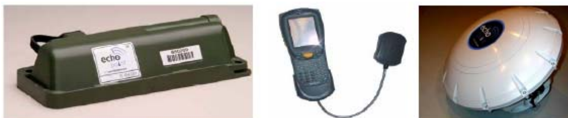
Figur 4.7 Aktiv RFID-brikke, håndholdt og stasjonær avleser (Kilde:[64])
