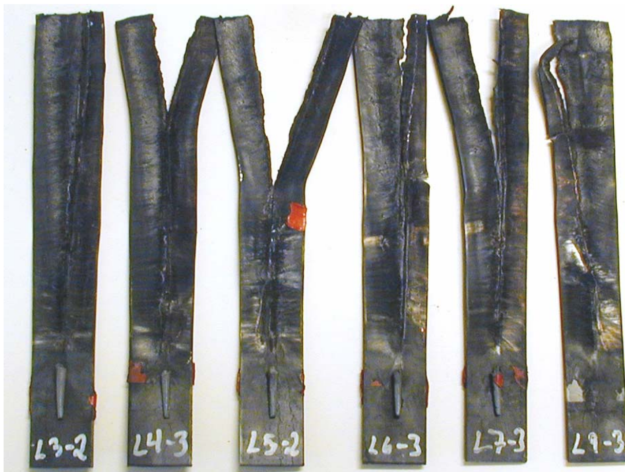
Figur 3.2 Bilde av vitneplater og rester av sprengstoffkoner etter omsetning av skuddene.
