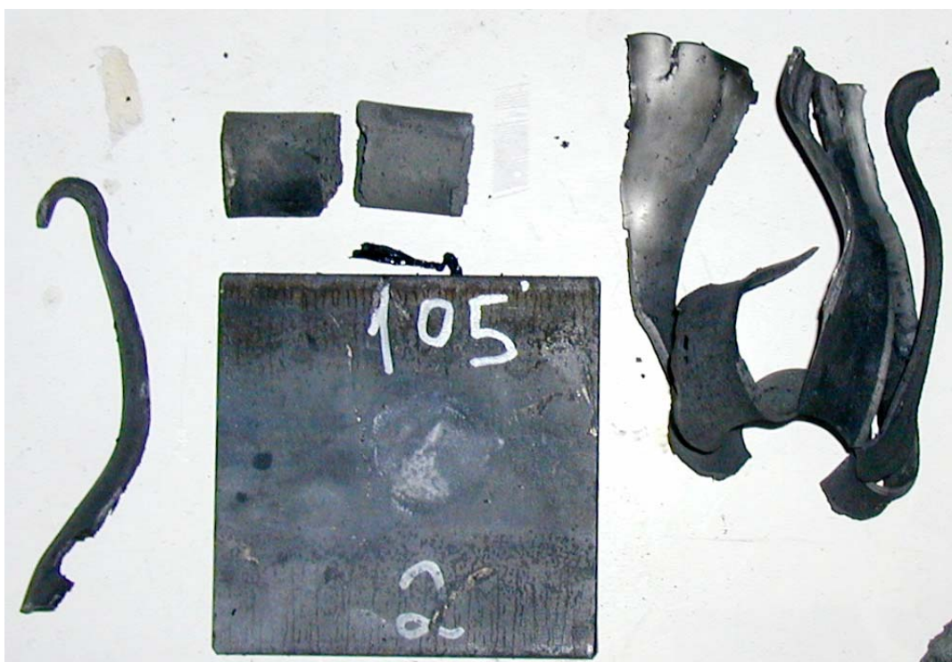
Figur 3.5 Skudd 2, rør 2 med PBXN-109 aldret i 18 mnd ved 60°C, 105 kort, ikke omsatt.
