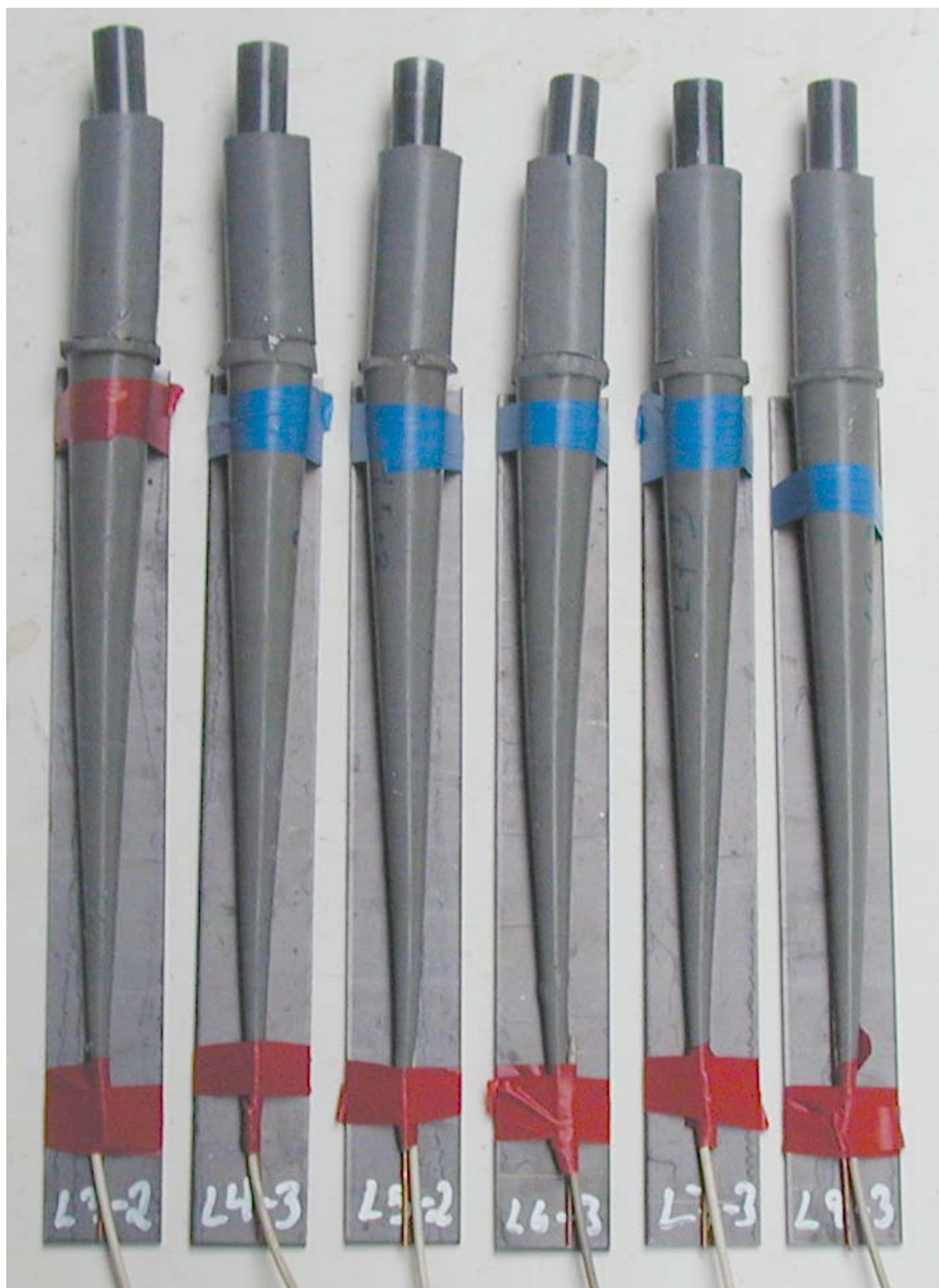
Figur 3.1 Sprengstoffkonene montert på vitneplatene.
