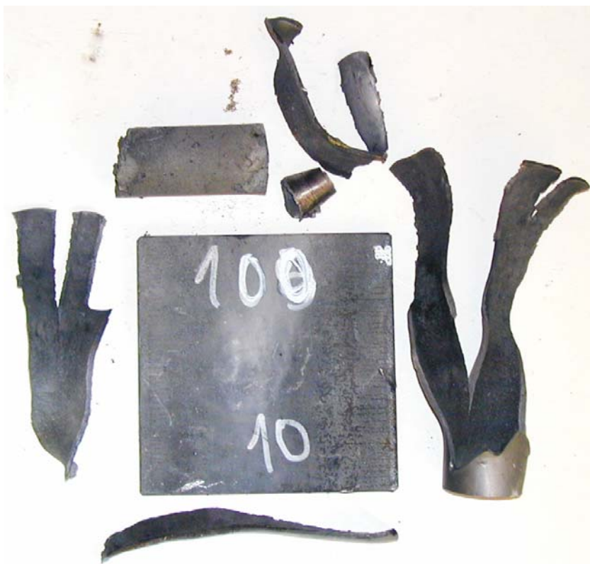
Figur 3.13 Skudd 10, rør 10 med PBXN-109 aldret i 18 mnd ved 60°C, 100 kort, ikke omsatt.
