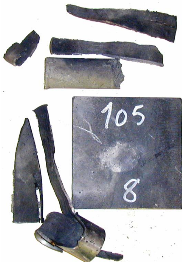
Figur 3.11 Skudd 8, rør 8 med PBXN-109 aldret i 18 mnd ved 60°C, 105 kort, ikke omsatt.
