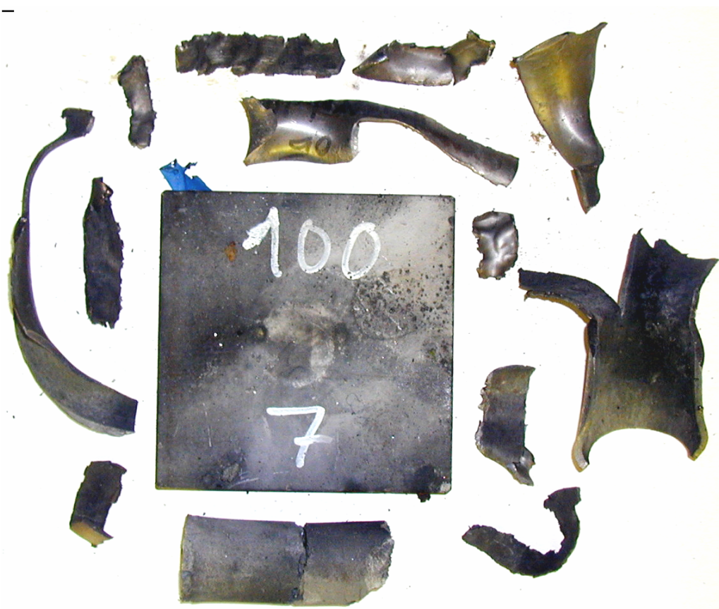
Figur 3.10 Skudd 7, rør 7 med PBXN-109 aldret i 18 mnd ved 60°C, 100 kort ikke omsatt.
