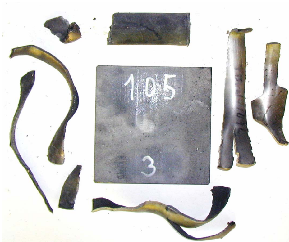
Figur 3.6 Sudd 3, rør 3 med PBXN-109 aldret i 18 mnd ved 60°C, 105 kort, ikke omsatt.
