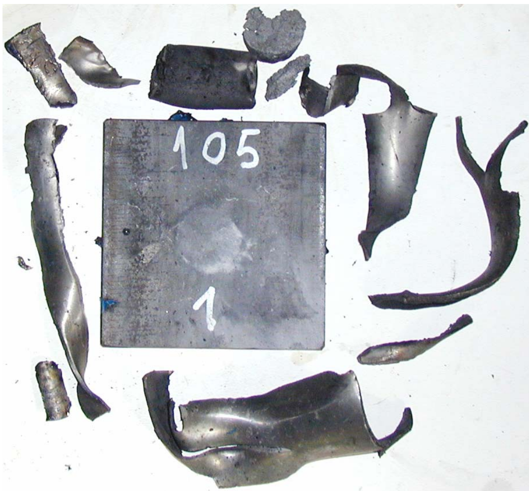
Figur 3.4 Skudd 1, rør 1 med PBXN-109 aldret i 18 mnd ved 60°C, 105 kort, ikke omsatt.
