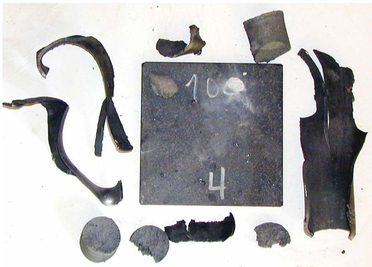
Figur 3.6 Sudd 3, rør 3 med PBXN-109 aldret i 18 mnd ved 60°C, 105 kort, ikke omsatt.
