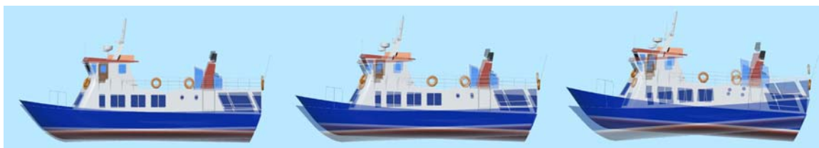
Figur 2.7 Eksempel på fartøy med \pm 1^\circ , \pm 2^\circ og \pm 4^\circ pitch-utslag
