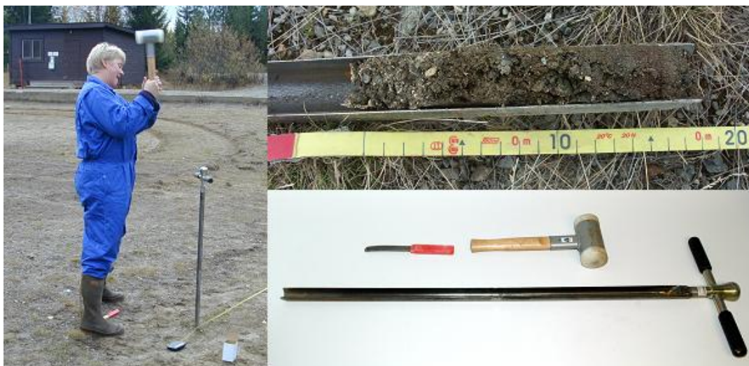
Figur 3.2 Jordbor benyttet til å ta kjerneprøver.
