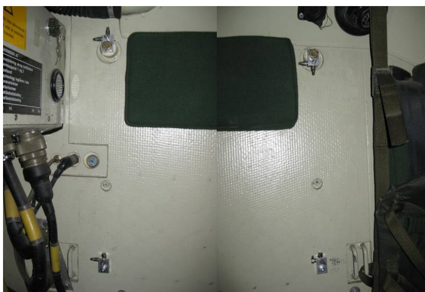
Figur 4.5 Plassering av aksellerometrene på den venstre veggen i stridsrommet
