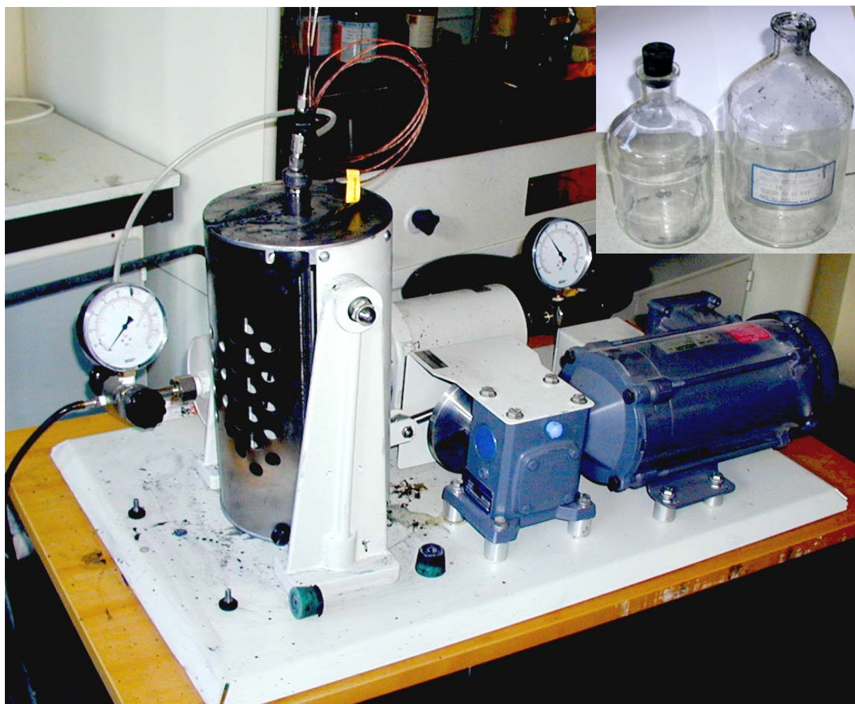
Figur 2.1 Parr hydrogeneringsapparat med glassreaktorene opp til høyre i bildet
