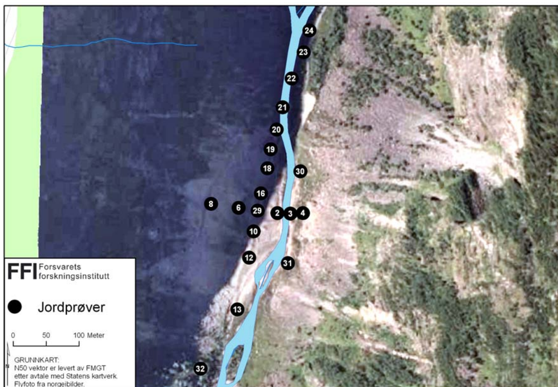
Figur 6.1 Forslag til plassering av prøvepunkter i demoleringsområdet.
