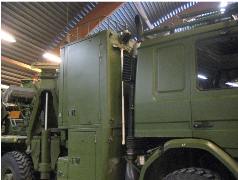
Figur 2.8 Eksosrør med utkast over førerhus på 113 H bergevogn.
