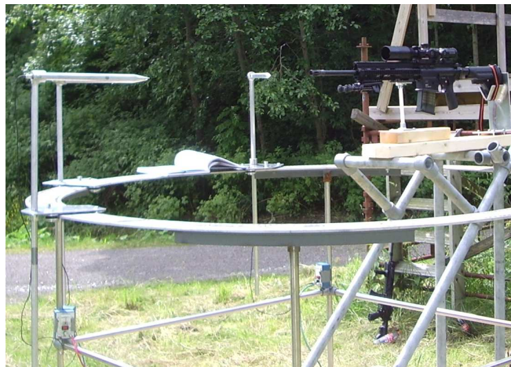
Figur 3.1: Målerigg for å måle trykk 80 cm fra munningen.
