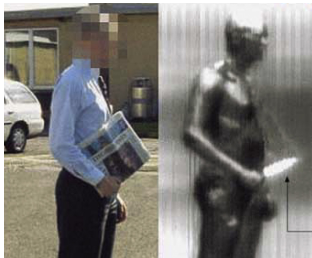
Figur 2.1 Person som skjuler knivblad oppdaget med THz-teknologi.
