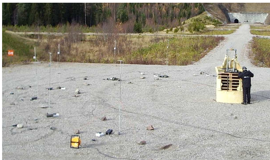
Figur 3.1: Måleoppsettet med 7 mikrofoner 10 m fra munningen.
