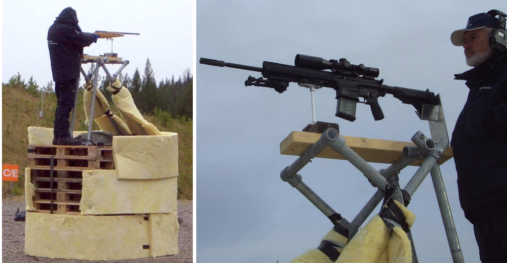
Figur 3.2: Måleriggen kledd med dempende materiale.
