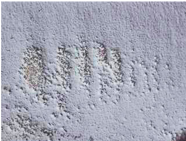
Bilde 3: K raform A50T etter behandling med laser med energi 132 mJ/puls i 30 sekunder. 100 ganger forst rrrelse ble benyttet.
