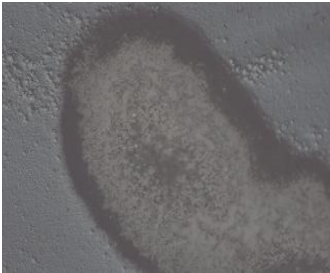
Bilde 4: K raform A50T etter behandling med laser med energi 132 mJ/puls i 30 sekunder.
