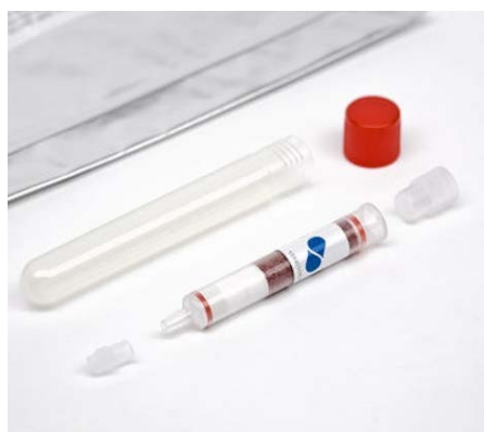
Figur 2.6 Skisse av SorbiCell (SorbiSense, 2012a)
