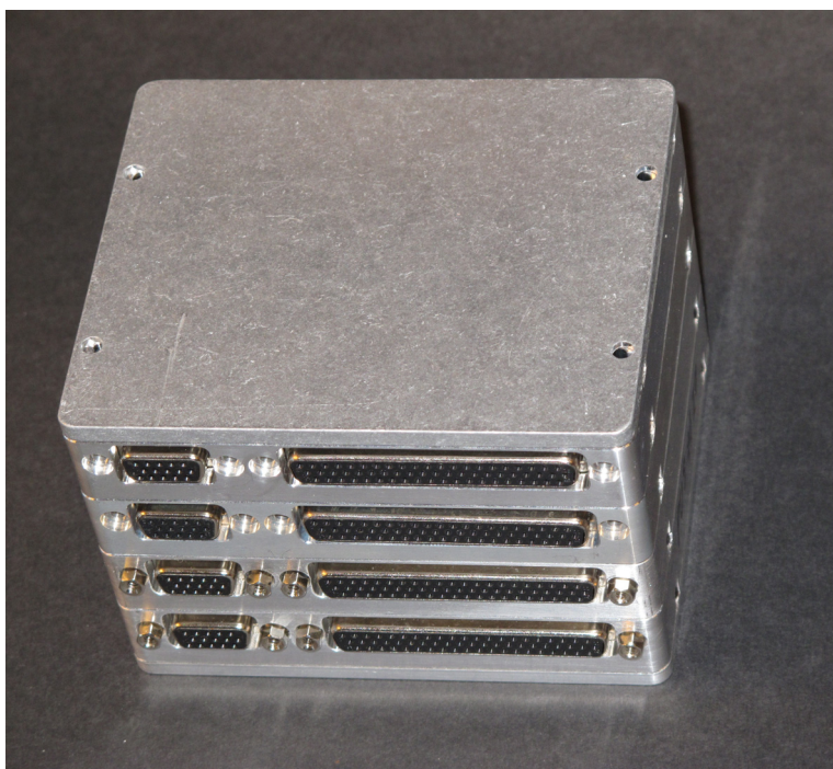
Figur 2.1 STAPPE, montert i rammer, klar til å monteres i en nyttelast
