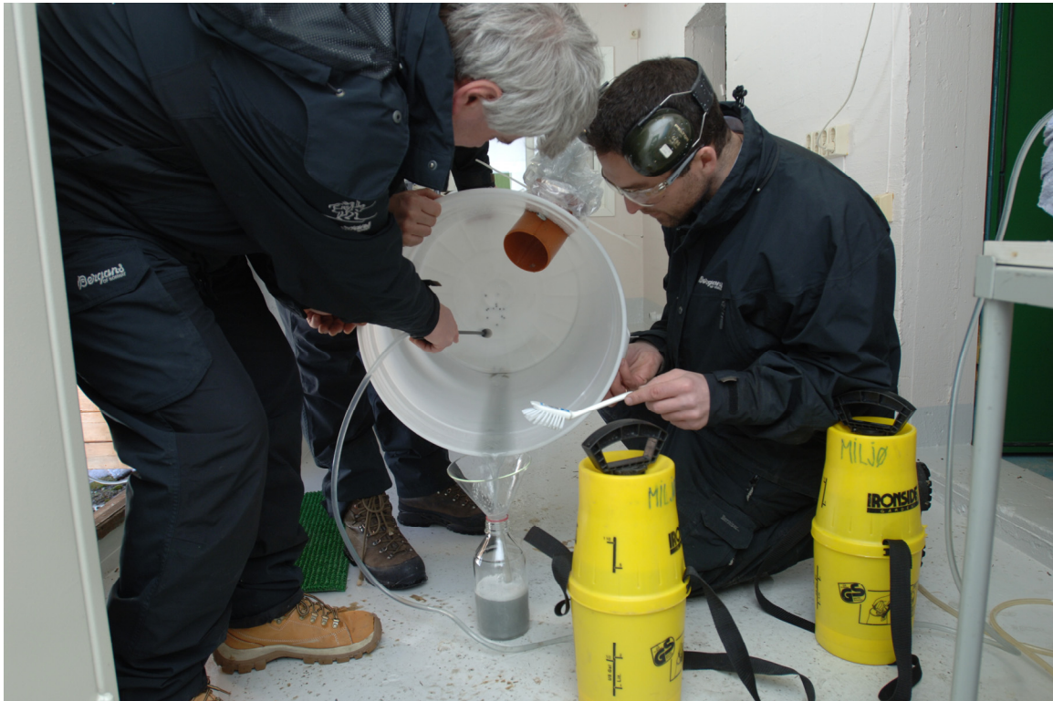
Figur 2.3 Skylling/vasking av beholder for å samle opp rester etter skyting med 10 skudd. Rester av krutt og metaller fra skytingen ble deretter analysert.
