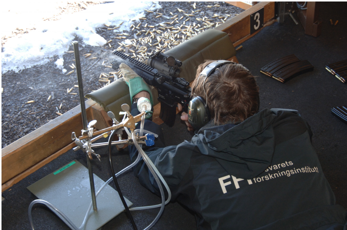
Figur 2.4 Skyting på lukket standplass for gjennomføring av Test II. Det ble utført gass og svevestøvsmålinger for å vurdere eksponeringen til en skytter.
