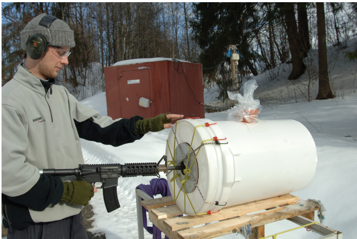
Figur 2.2 Skyting gjennom oppsamlingsbeholder for analyse av avgasser og partikler (Våpenet vist på bildet er en Colt C8).
